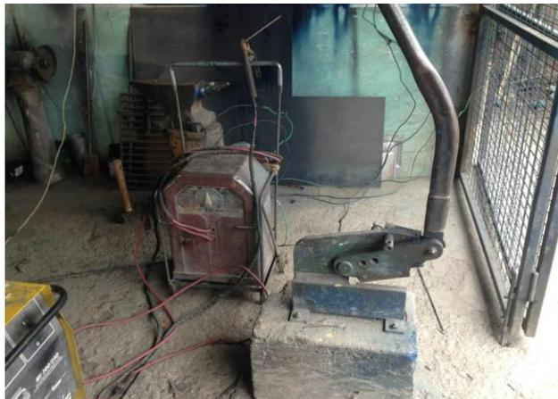
Figura 1.21: Malas técnicas de seguridad, maquina embancada inadecuadamente.
