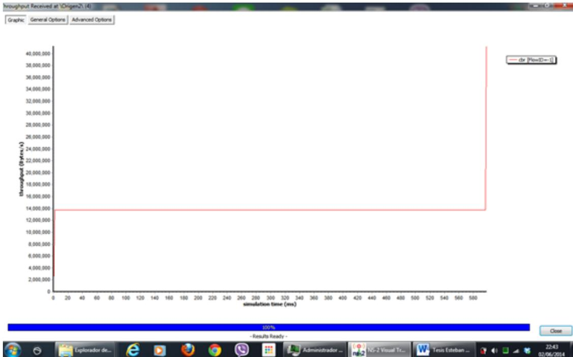
**Fig. A30:** Medición del Throughput Recibido Nodo(4) “Origen2” cambiando el tiempo de muestreo de los paquetes CBR en norma g.
