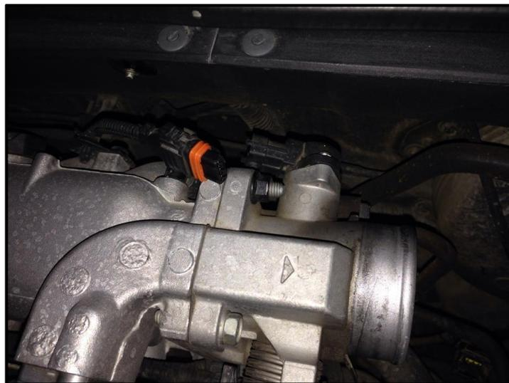
*Figura 5.102. Desconexión de sensor TPS*
