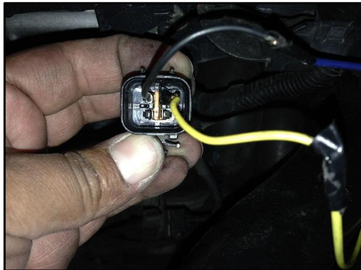
*Figura 5.43. Conexión del sensor HO2S al equipo.*
