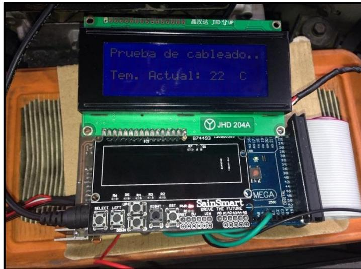
*Figura 5.74. Interface de prueba sensor IAT a 22°C*
