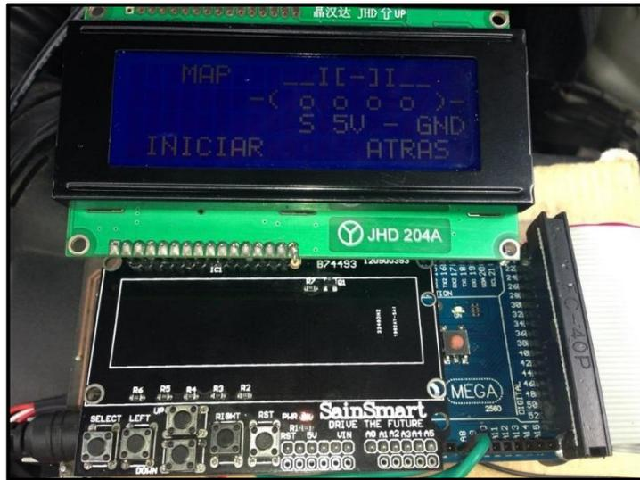
*Figura 5.78. Interface de conexión para prueba sensor MAP*
