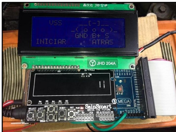
*Figura 5.49. Interface de conexión para probar sensor VSS*
