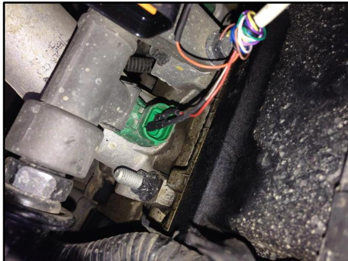
*Figura 5.87. Conexión del inyector al equipo*
