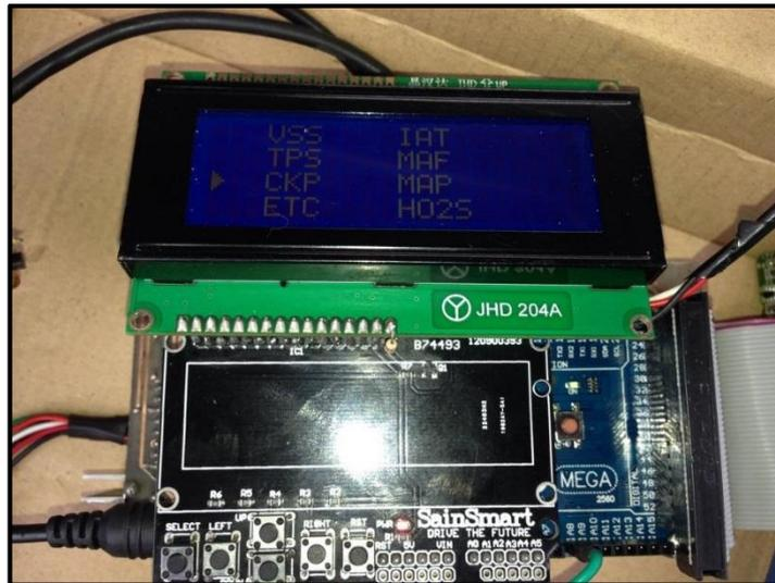
*Figura 5.20. Interface de selección para simulación de sensor CKP*
