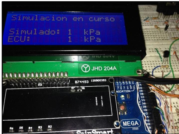
*Figura 5.39 Interface de simulación sensor IAT a 1 KPa*
