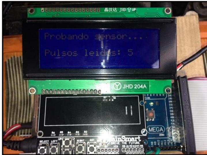
*Figura 5.64. Interface de prueba sensor CMP a 5 pulsos*
