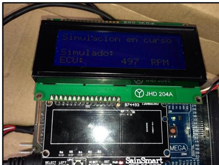
*Figura 5.23. Interface de simulación sensor CKP a 497 rpm*
