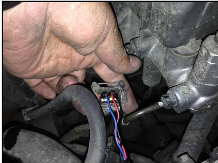
*Figura 5.11. Conexión VSS al equipo*
