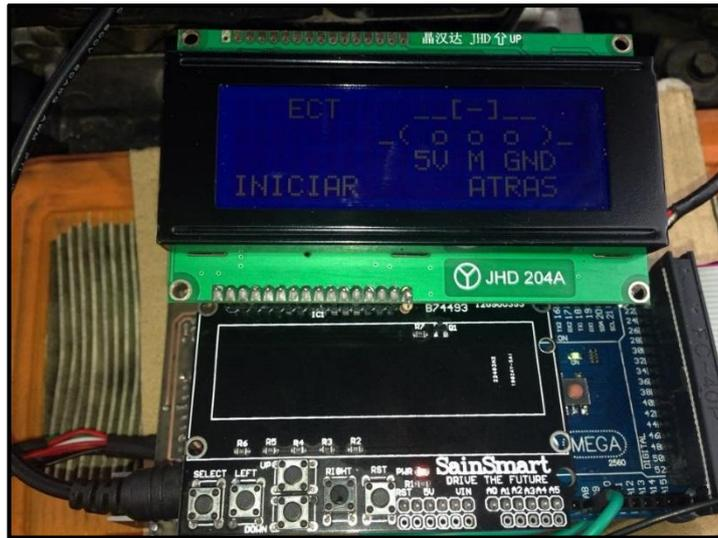
*Figura 5.68. Interface de conexión para prueba sensor ECT*
