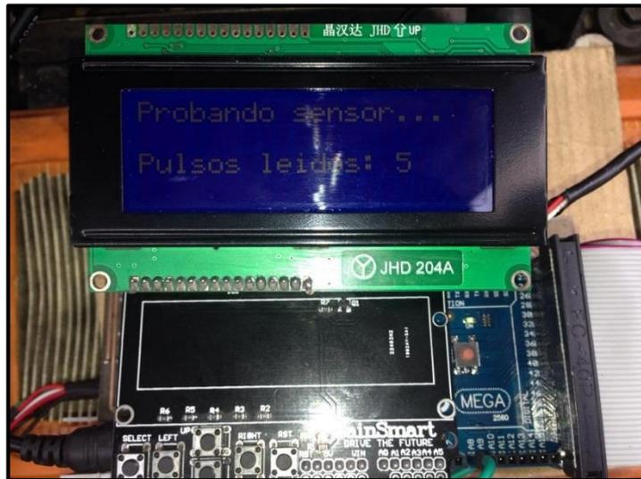
*Figura 5.51. Interface de prueba de sensor VSS a 5 pulsos.*
