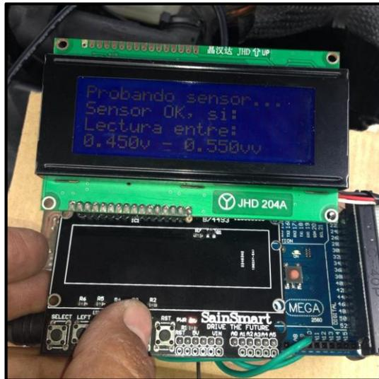
*Figura 5.84. Interface de prueba sensor HO2S con valores de referencia*
