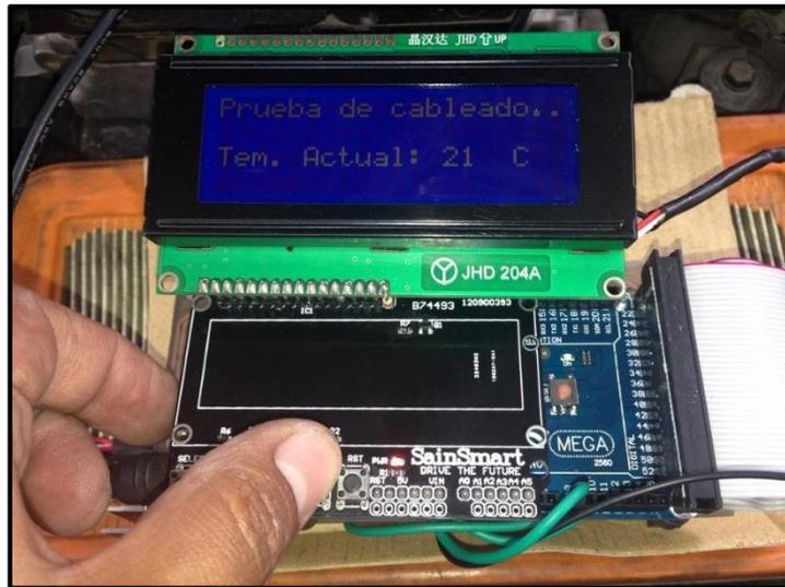
*Figura 5.73. Interface de prueba sensor IAT a 21°C*
