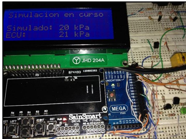
*Figura 5.40 Interface de simulación sensor IAT a 21 KPa*
