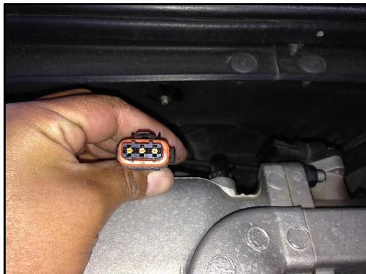
*Figura 5.16. Conector del sensor TPS*
