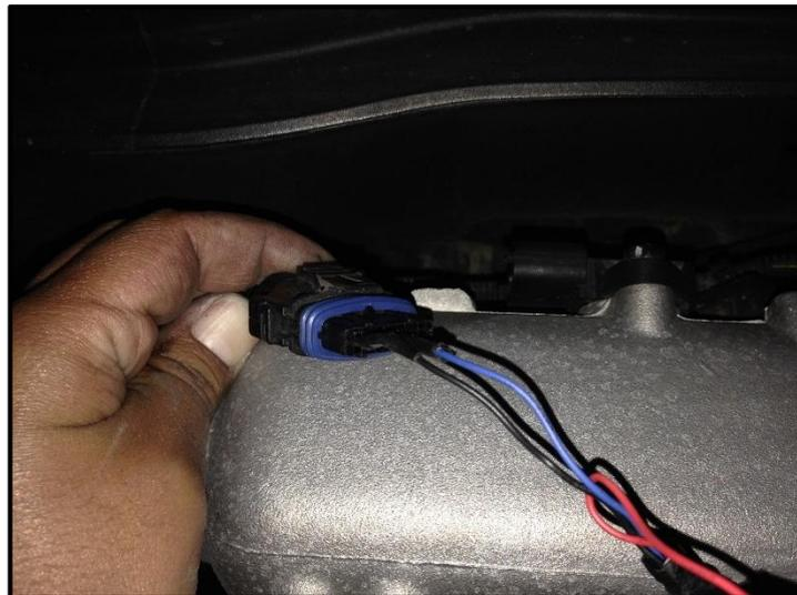
*Figura 5.33 Conexión del sensor IAT al equipo*
