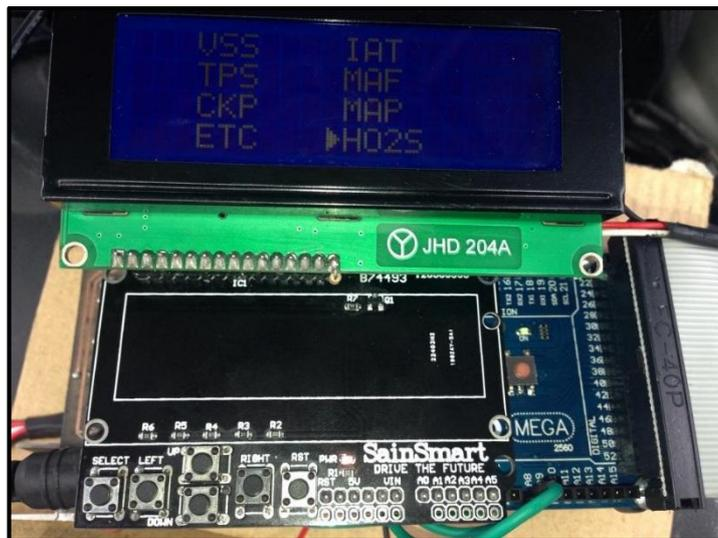
*Figura 5.81. Interface de selección de prueba sensor HO2S*
