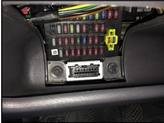
*Figura 5.1. Conector OBD2 en el automóvil*
