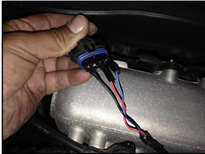
*Figura 5.38 Conexión de sensor MAP al equipo.*
