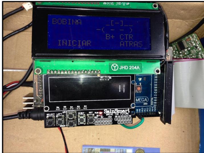
*Figura 5.90. Interface de activación de la bobina de encendido*
