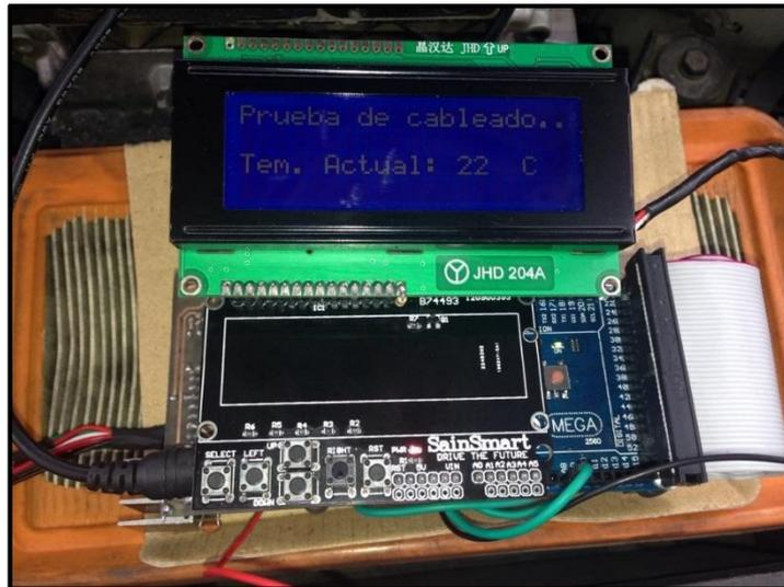
*Figura 5.70. Interface de prueba sensor ECT a 22°C*
