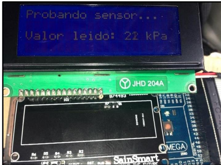
*Figura 5.79. Interface de prueba sensor MAP a 21 KPa*
