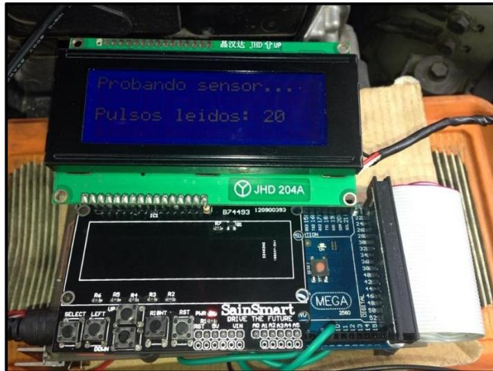
*Figura 5.66. Interface de prueba sensor CMP a 20 pulsos*
