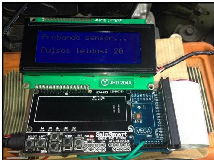
*Figura 5.53. Interface de prueba de sensor VSS a 20 pulsos.*
