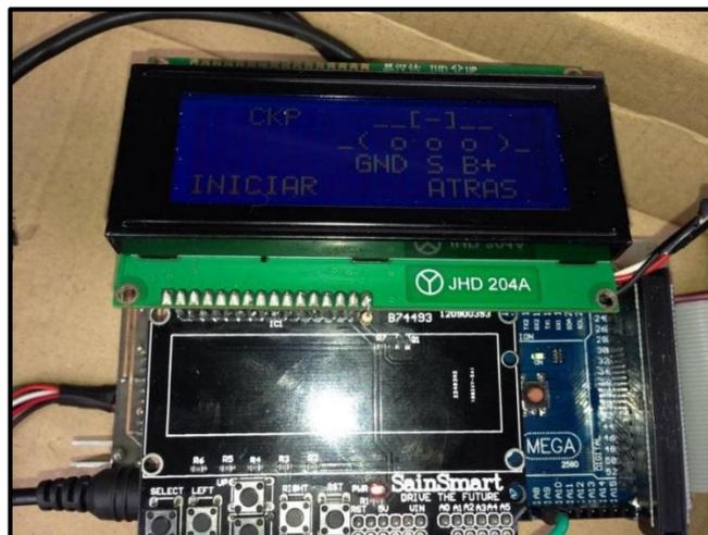
*Figura 5.21. Interface de conexión del sensor CKP*
