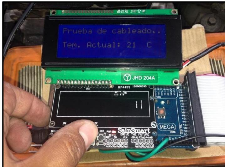
*Figura 5.69. Interface de prueba de sensor ECT a 21°C*
