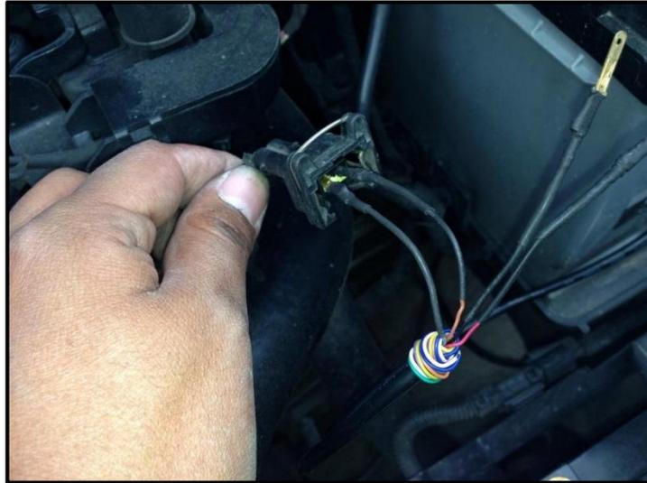
*Figura 5.22. Conexión del sensor CKP al equipo*
