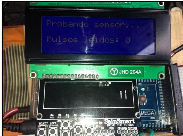
*Figura 5.63. Interface de prueba sensor CMP*
