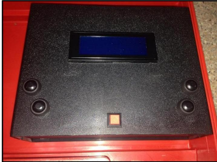
*Figura 5.109. Equipo de diagnóstico de sensores actuadores y ECU's automotrices*
