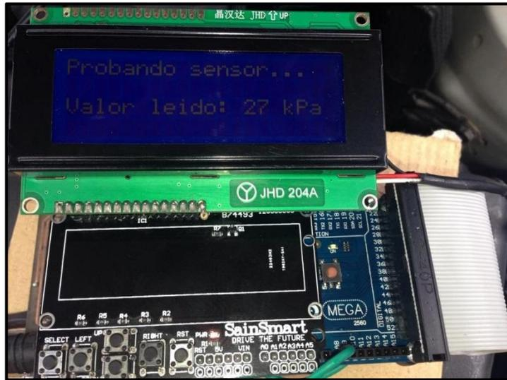
*Figura 5.80. Interface de prueba sensor MAP a 27 kPa*
