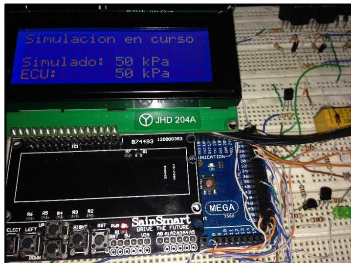
*Figura 5.41 Interface de simulación sensor IAT a 50 KPa*
