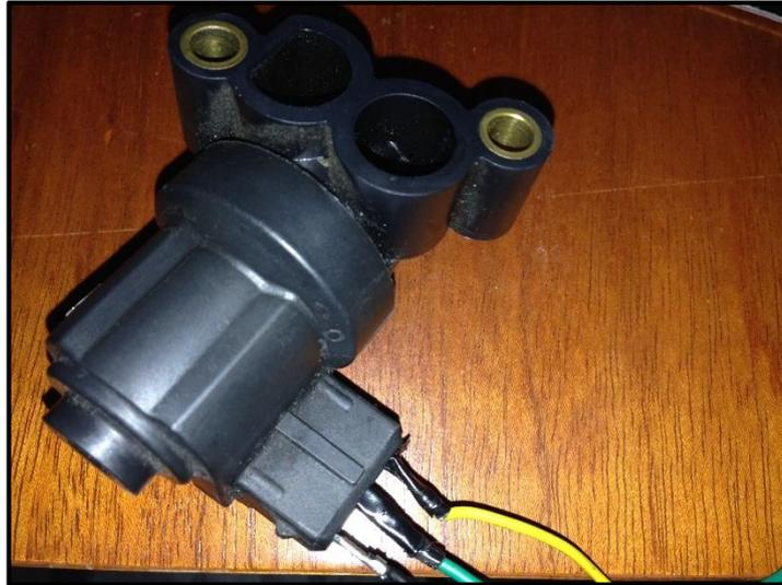
*Figura 5.96. Conexión de la IAC al equipo*
