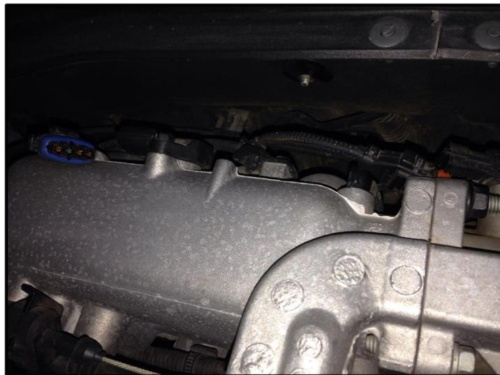
*Figura 5.104. Desconexión del sensor MAP*
