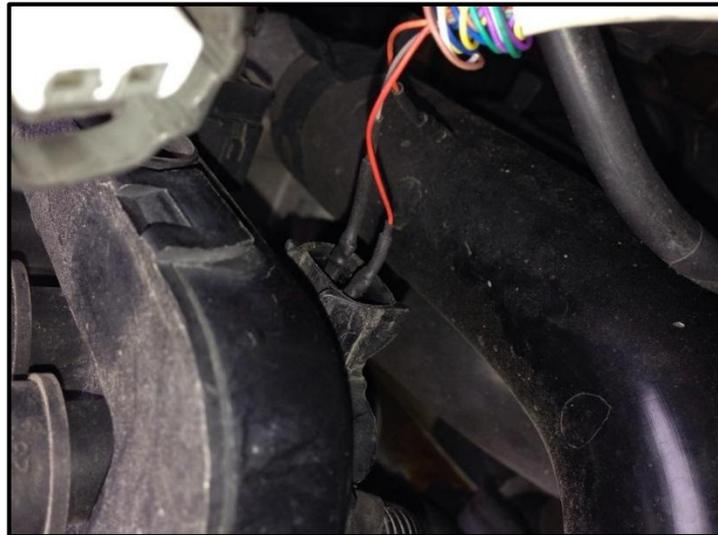
*Figura 5.89. Conexión de una bobina de encendido al equipo*
