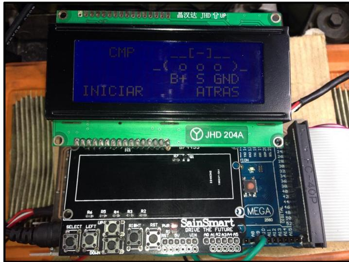
*Figura 5.62. Interface de conexión para prueba de sensor CMP*
