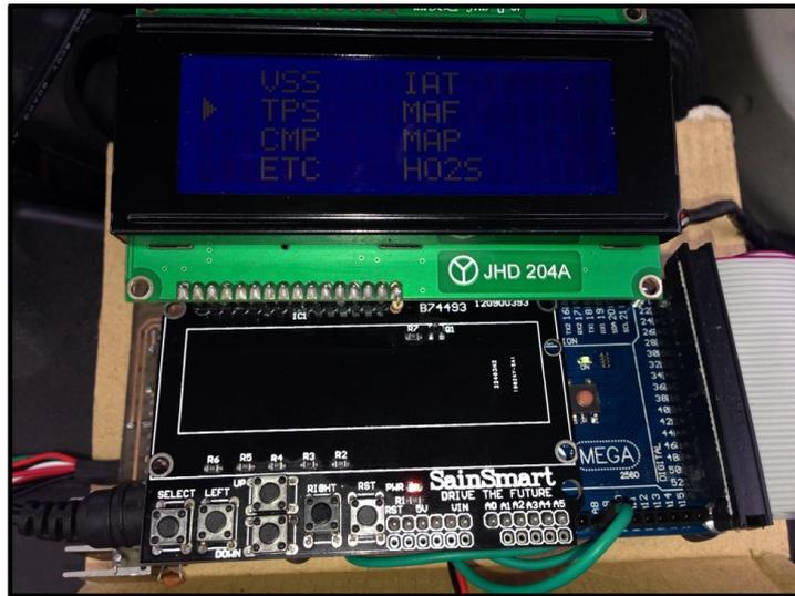
*Figura 5.54. Interface de selección para prueba de sensor TPS.*
