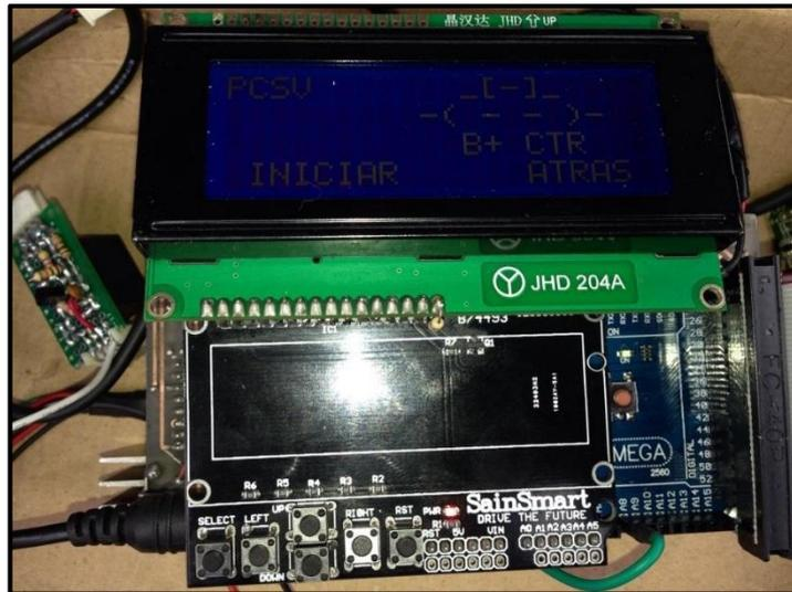
*Figura 5.99. Interface de activación PCSV*
