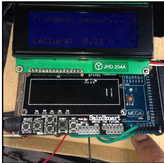
*Figura 5.83. Interface de prueba sensor HO2S a 0.11V*
