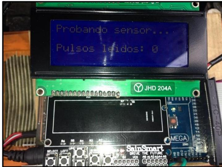
*Figura 5.50. Interface de prueba de sensor VSS*
