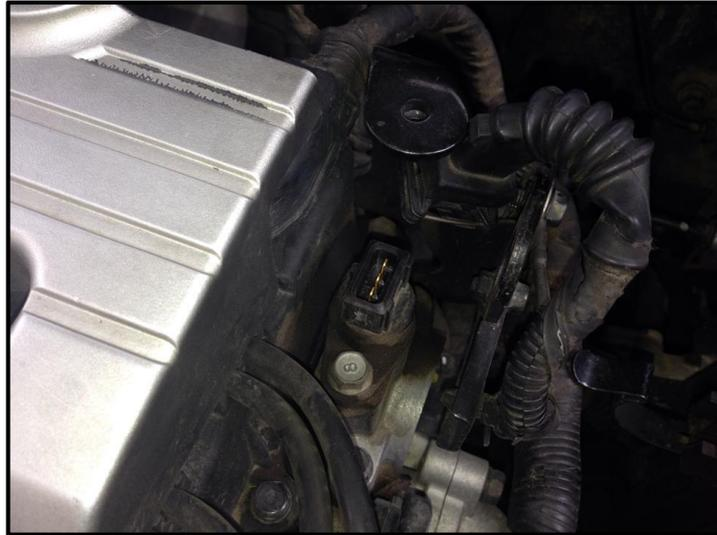
*Figura 5.60. Ubicación del sensor CMP en el automóvil*
