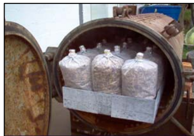
Fotografía 4. Autoclave, fundas a ser desinfectadas.
