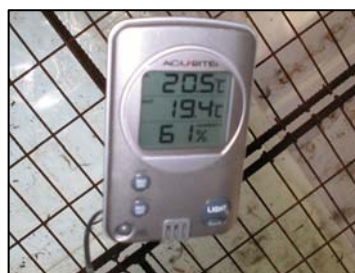
Fotografía 15. Tumbado de plástico y equipo para tomar datos de temperatura y humedad.
