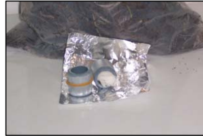
Fotografía 3. Materiales para sellado de funda (Anillo de PVC, gasa, liga, papel aluminio)
