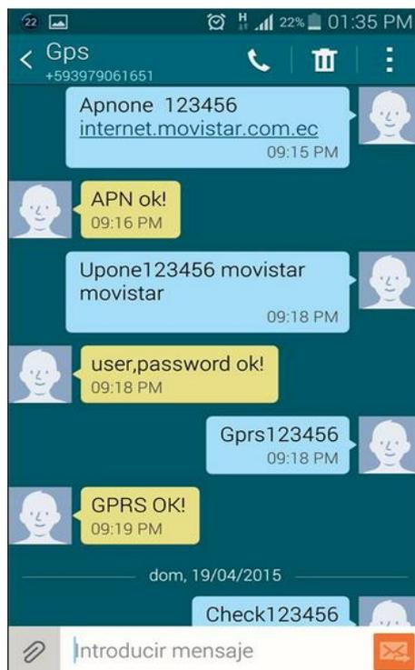
Ilustración 7 Configuración SMS APN
