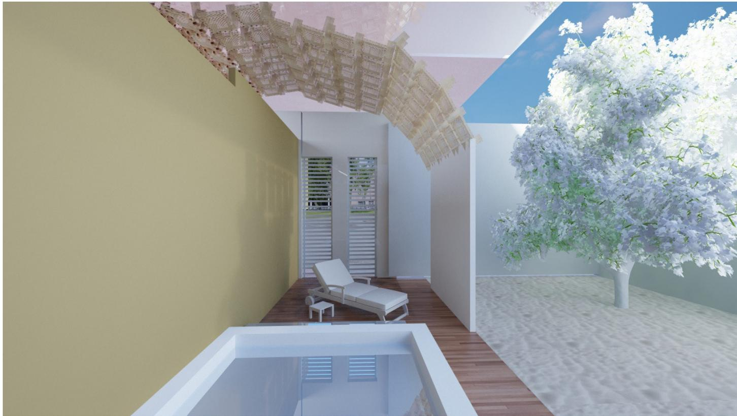
Se propuso por medio de una malla armex tejer la paja toquilla en esta y que no sea visible la malla existente. Se utilizó la malla para poder potenciar la excelente ventaja de la toquilla que es la flexibilidad, mediante esto el módulo puede ser dirigido de cualquier forma e ir formando de diferentes tipos y tamaños.
