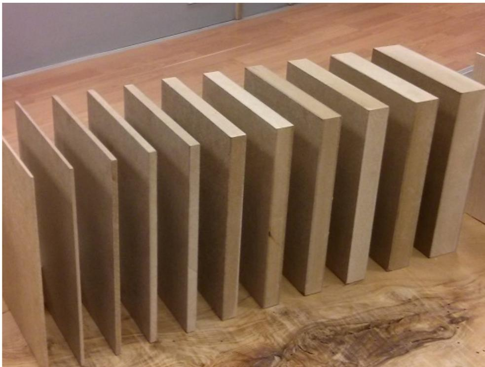
*Luego de tener los tablones de madera para su respectivo procesamiento conseguimos los tableros de MDF los cuales están especificados en la hoja de conducción en el cual se indica los espesores que se utilizaran en este caso son tableros de 30mm y 6mm de espesor en tableros sin chapa de madera.*
