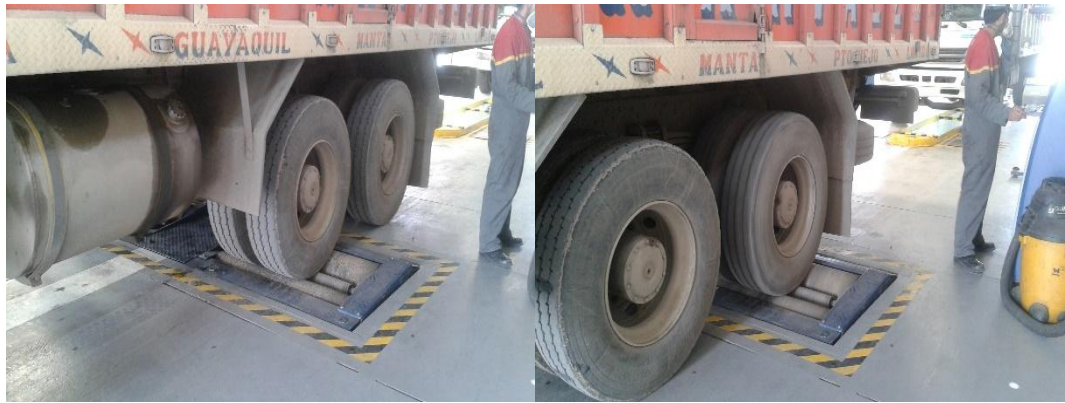
Figura 66. Prueba de frenado, en la línea de revisión para vehículos pesados Nro. 1 del centro de Mayancela.
