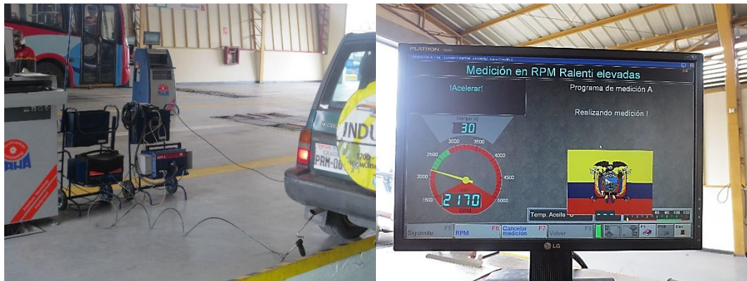
Figura 56. Prueba de gases, en la línea de revisión mixta Nro. 3 del centro de Mayancela.
