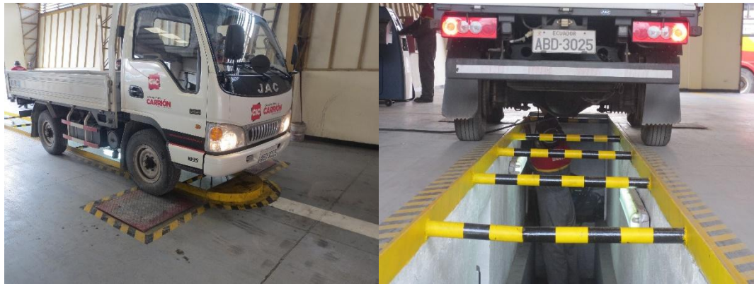
Figura 63. Prueba de holguras, en la línea de revisión para vehículos pesados Nro. 1 del centro de Mayancela.
