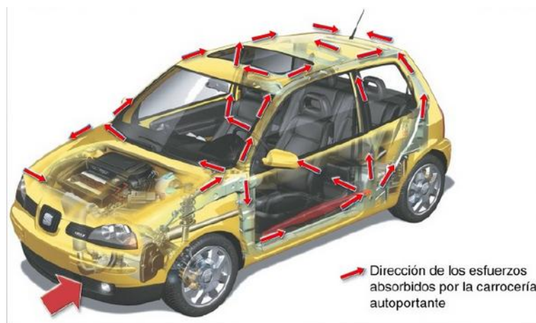
Figura 10. Sistema de protección esquemático en un vehículo.
