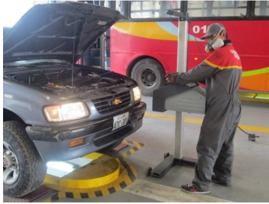
Figura 55. Prueba de luces, en la línea de revisión para vehículos livianos Nro. 2 del centro de Mayancela.
