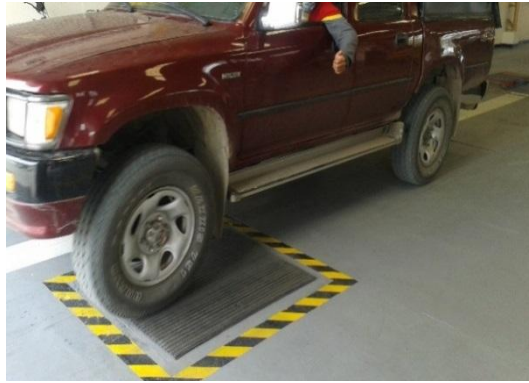
Figura 59. Prueba de deriva dinámica, en la línea de revisión mixta Nro. 3 del centro de Mayancela.
