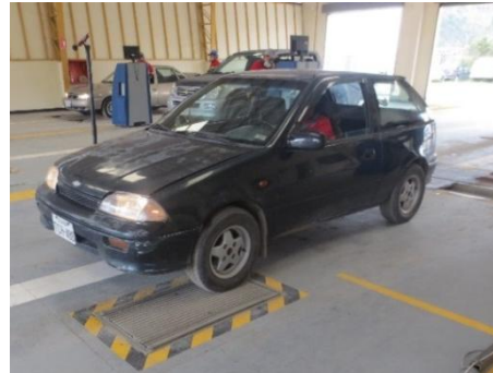
Figura 76. Prueba de deriva dinámica, en la línea de revisión Nro. 2 del centro de Capulispamba.
