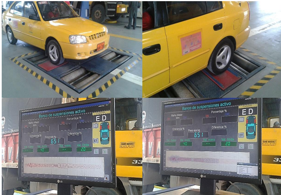
Figura 57. Prueba de suspensiones, en la línea de revisión para vehículos livianos Nro. 2 del centro de Mayancela.
