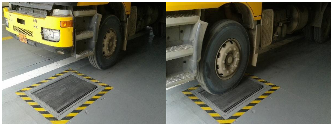
Figura 67. Prueba de deriva dinámica, en la línea de revisión para vehículos pesados Nro. 1 del centro de Mayancela.
