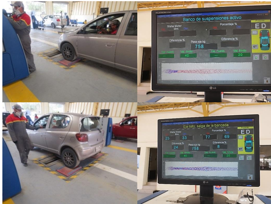
Figura 74. Prueba de suspensión, en la línea de revisión Nro. 2 del centro de Capulispamba.
