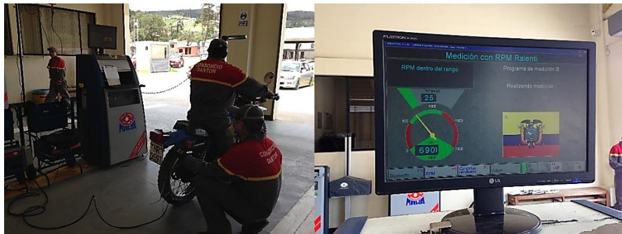
Figura 81. Prueba de gases, en la línea de revisión Nro. 3 del centro de Mayancela.
