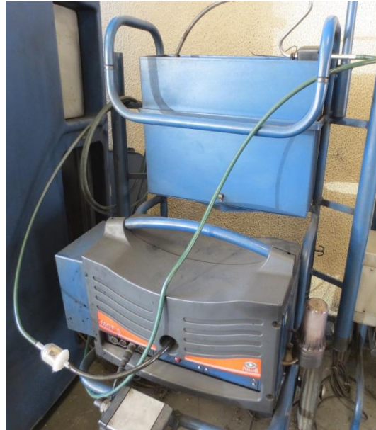
Figura 33. Analizador de gases MAHA MGT 5.
