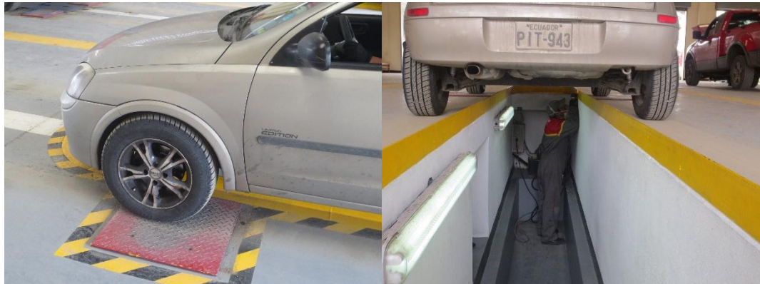
Figura 73. Prueba de holguras, en la línea de revisión Nro. 2 del centro de Capulispamba.
