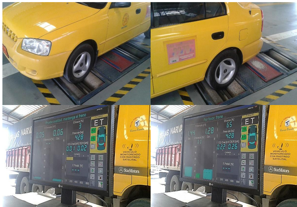
Figura 58. Prueba de frenado, en la línea de revisión para vehículos livianos Nro. 2 del centro de Mayancela.
