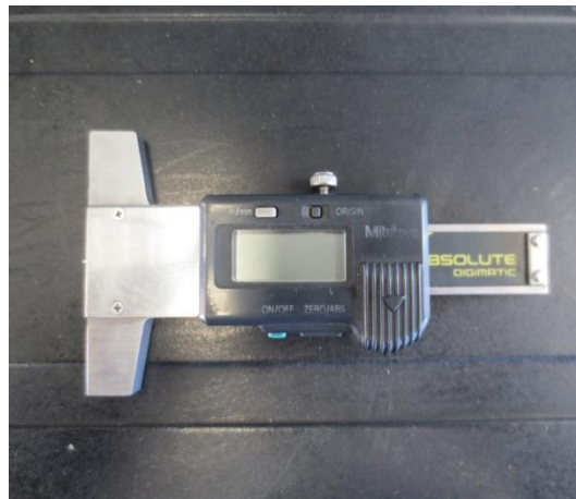
Figura 38. Detector de profundidad de labrado de neumáticos MITUTOYO Digimatic MyCAL ABSOLUTE.
