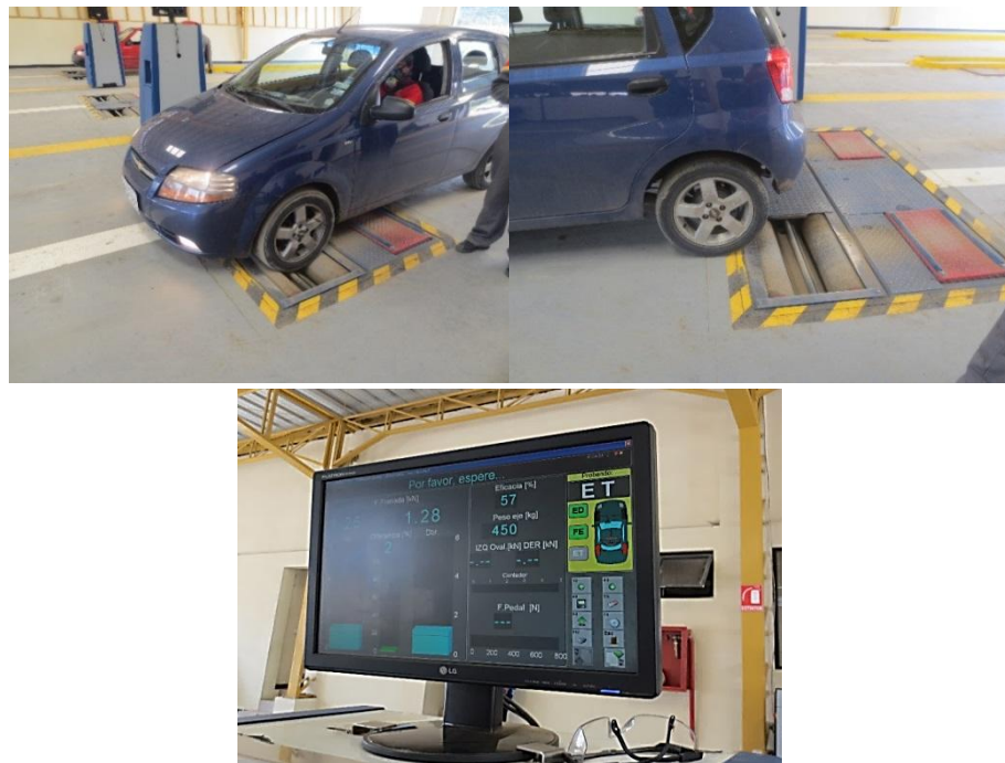
Figura 75. Prueba de frenado, en la línea de revisión Nro. 2 del centro de Capulispamba.
