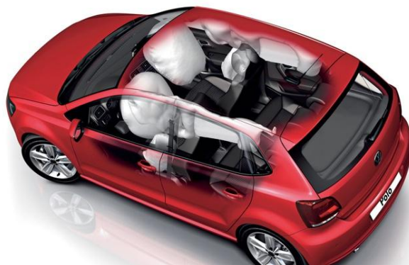
Figura 12. Sistema de retención esquemático de un vehículo.
