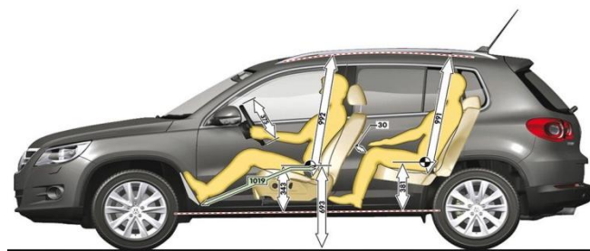
Figura 8. Sistema de ergonomía esquemático de un vehículo.
