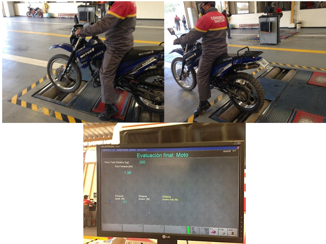
Figura 70. Prueba de frenado, en la línea de revisión Nro. 2 del centro de Mayancela.
