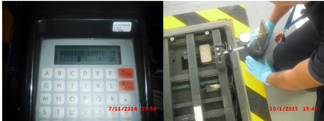
Figura 85. Verificación de tolerancias de equipos (Opacímetro y banco de deriva dinámica)
