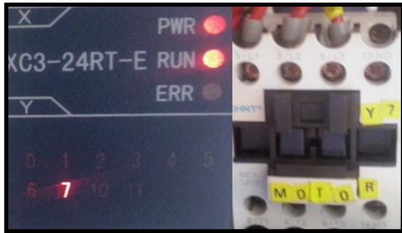
Figura 5. 28. Señal de salida para contactor motoreductor.
