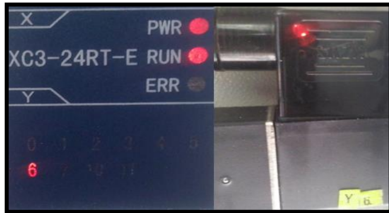
Figura 5. 27. Señal de salida para pistón superior retroceso.
