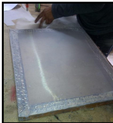
Figura 3. 16. Colocación de malla sobre marco.
