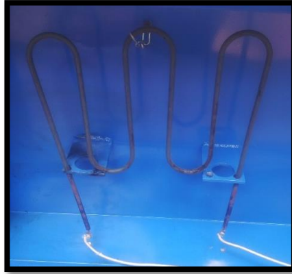
Figura 3. 58. Niquelina eléctrica usada en el sistema de secado.
