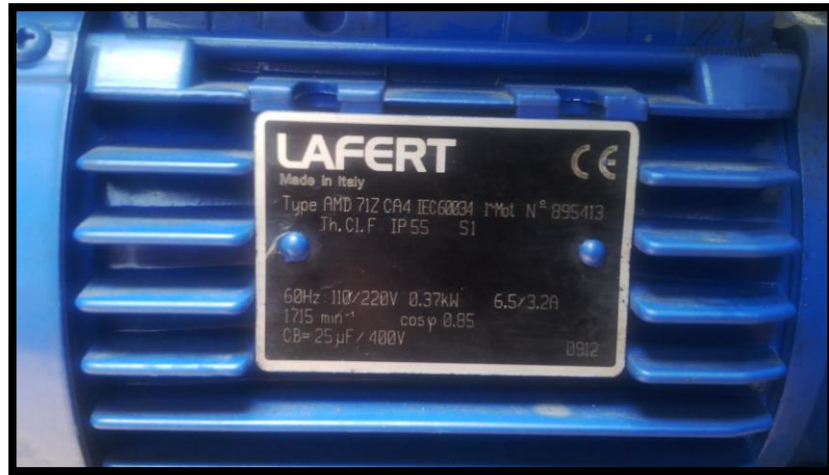
Figura 3. 55. Placa de datos de motor eléctrico.
