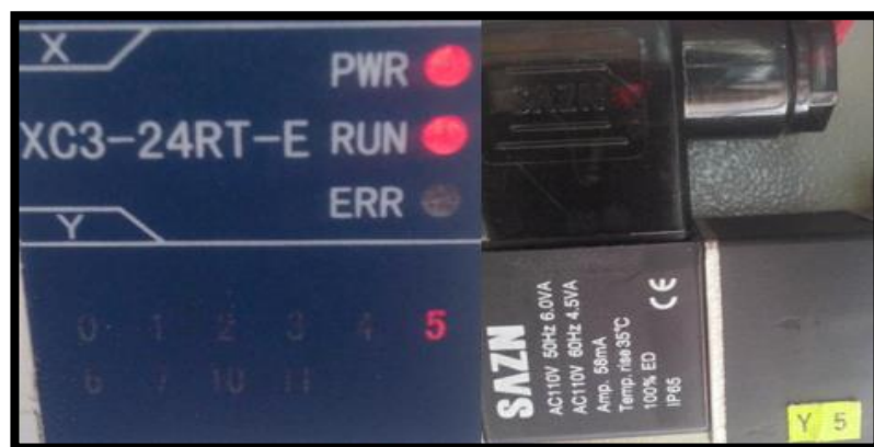
Figura 5. 26. Señal de salida para pistón superior avance.
