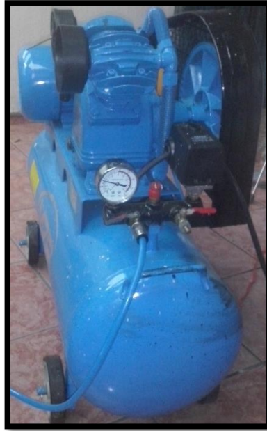
Figura 5. 12. Fuente de aire compresor 7.1 cfm 2HP
