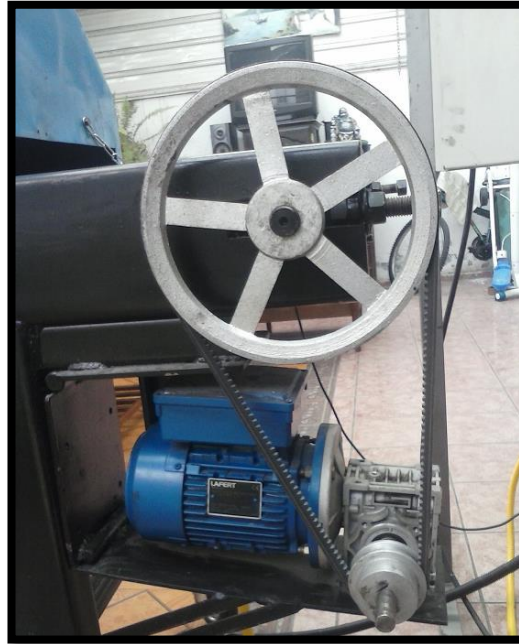
Figura 3. 57. Técnica de reducción de velocidad por poleas.
