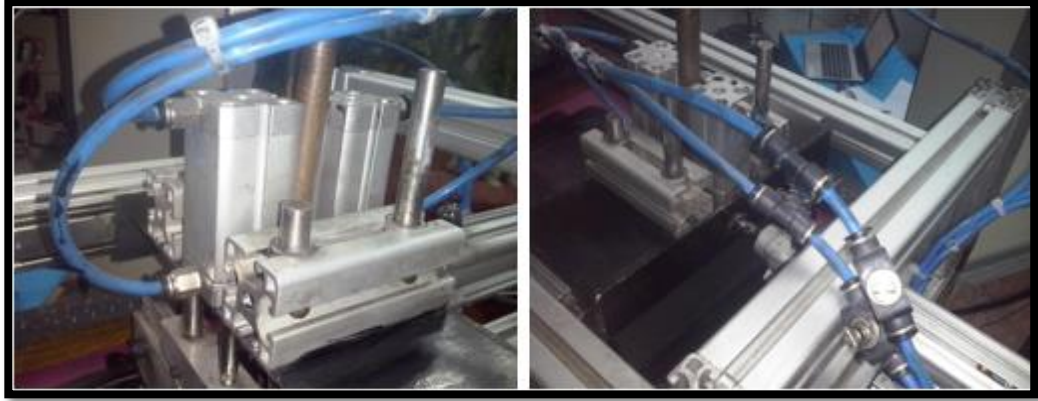
Figura 5. 16. Conexión neumática tipo “X” para pistón racle y rascador con regulador.
