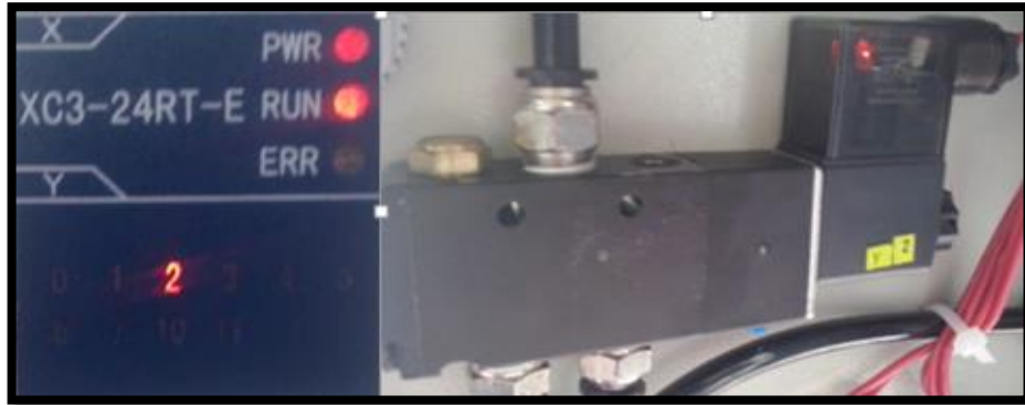
Figura 5. 23. Señal de salida hacia pistón mesa.
