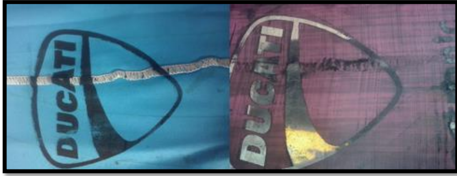
Figura 5. 68. Malla de diseño deteriorada debido al textil perturbado.
