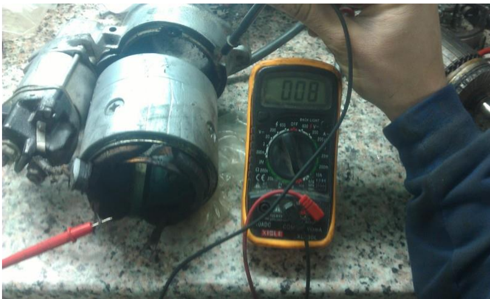
Fig.4.4 Comprobación de continuidad entre las bobinas del relé del motor de arranque
