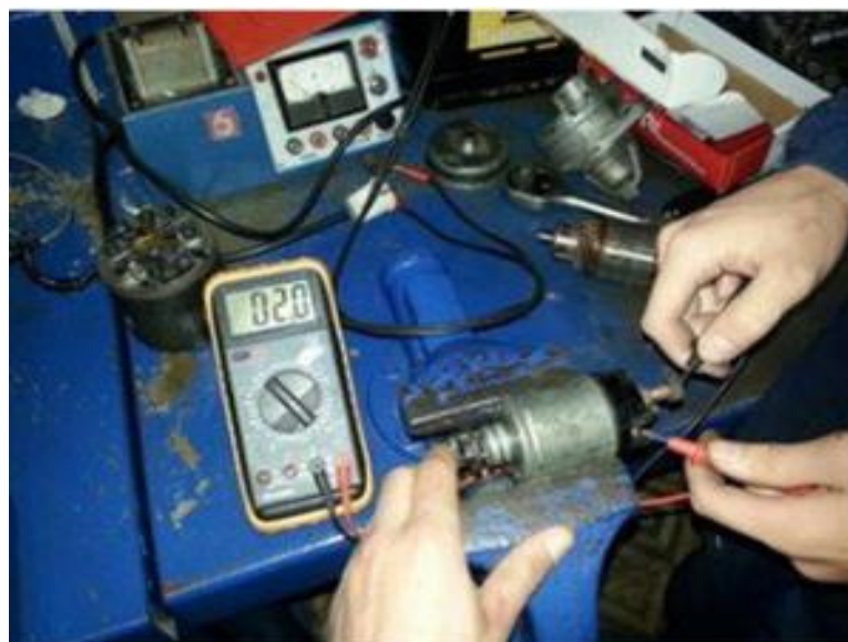
Fig.4.6 Prueba del funcionamiento del relé del motor de arranque
