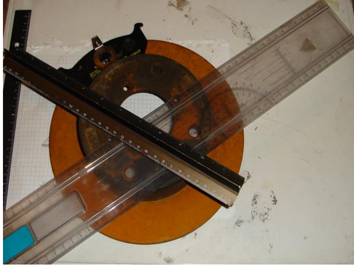
Fig. 2.23 Medición 1 para el cálculo de la fuerza de frenado del banco de pruebas del motor de arranque Fuente: Autores
