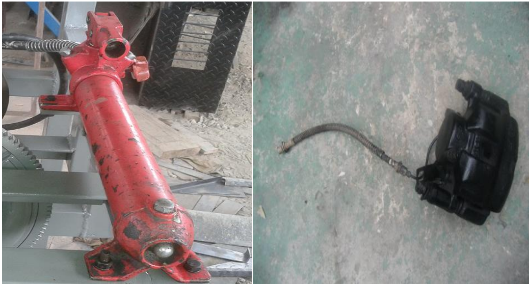
Fig. 3 .23. Sistema de freno del banco del motor de Arranque
