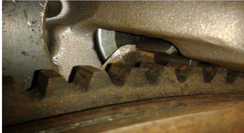
Fig. 3 .5. Acople entre el piñón de arranque y la corona dentada
