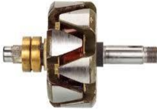
Fig. 1.26. Forma de las bobinas inductoras
