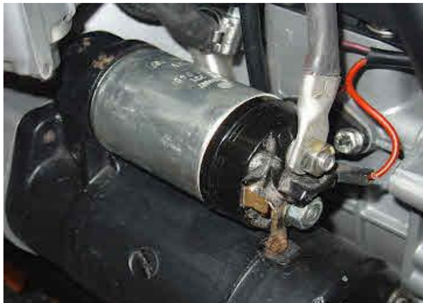
Fig.4.13 Comprobación de accionamiento del relé del motor de arranque.
