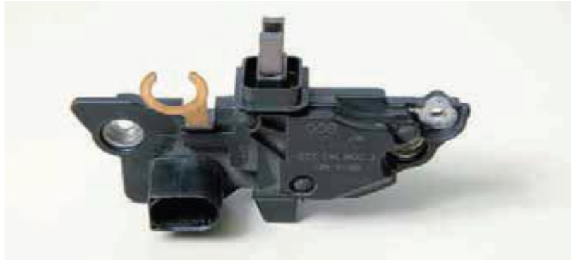
Fig. 1.34. Regulador Electrónico del alternador
