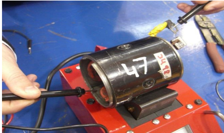
Fig.4.5 Comprobación de continuidad entre las bobinas inductoras y la carcasa
