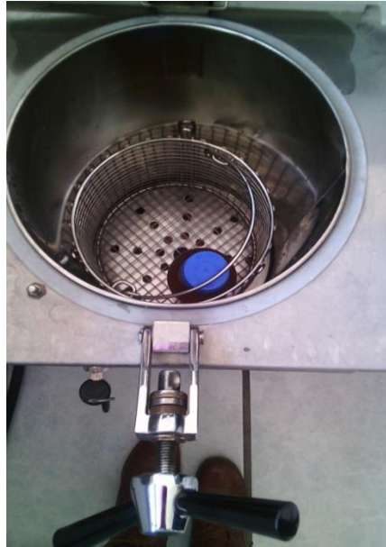
Preparación Agar Sabourad - Autoclave
