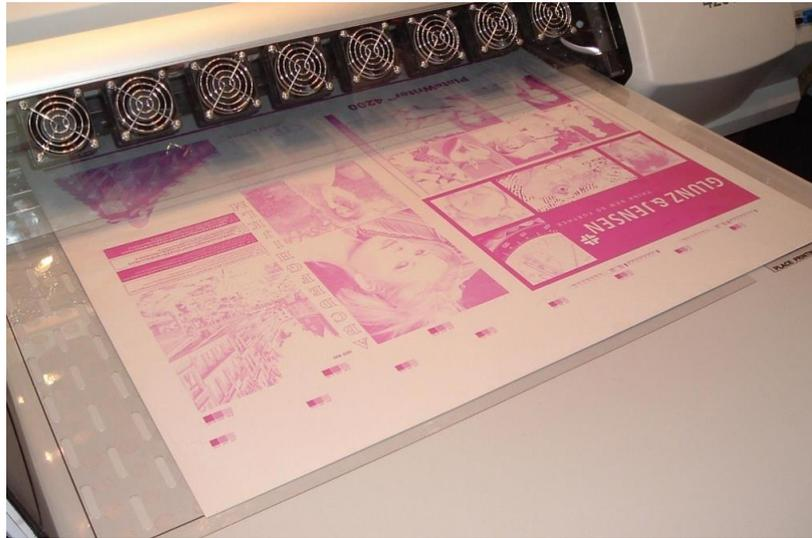
Figura 2.4. Placa de aluminio impresa por un equipo CTP
