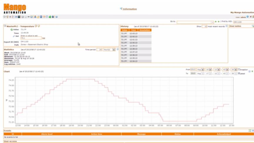
Figura 1.15. Integración de PLC mediante Modbus en Mango
