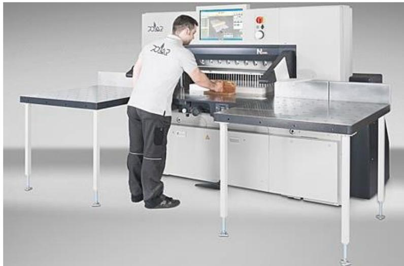
Figura 2.6. Operario ingresando los pliegos de papel en una guillotina.
