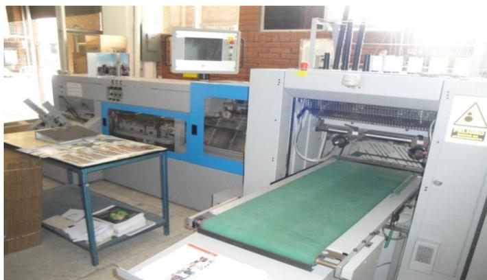
Figura 2.9. Máquina automática de cosido existente en la Editorial Don Bosco.
