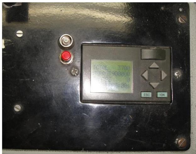
Figura 2.20. Contador de dobleces ubicado en las máquinas de doblado
