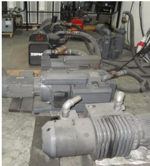
Figura 2.26. Compresores generales utilizados para las prensas
