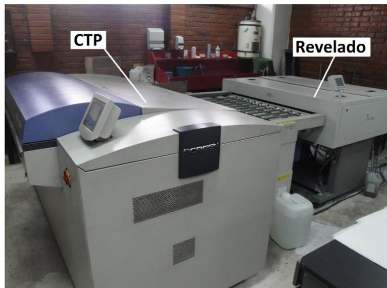
Figura 2.3. Máquina de preprensa
