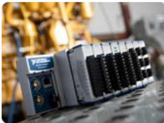
Figura 1.3. Sistema de adquisición de datos de National Instruments
