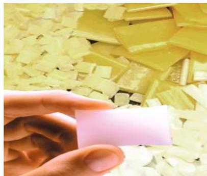
Figura 2.23. Adhesivo Hot melt HM1952C para lomo de libros.
