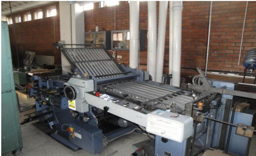
Figura 2.8. Máquina de doblado existente en la Editorial Don Bosco
