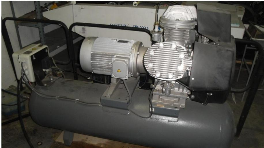
Figura 2.12. Compresor de aire para alimentación de prensas
