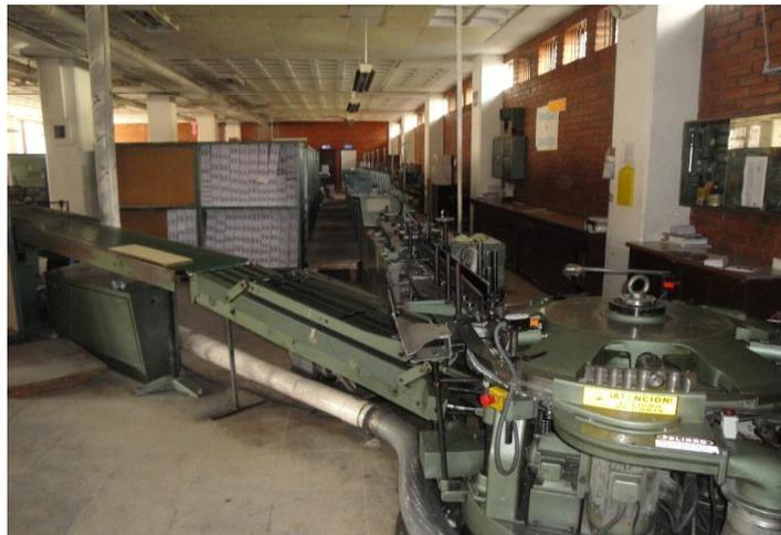
Figura 2.10. Máquina de encolado existente en la Editorial Don Bosco
