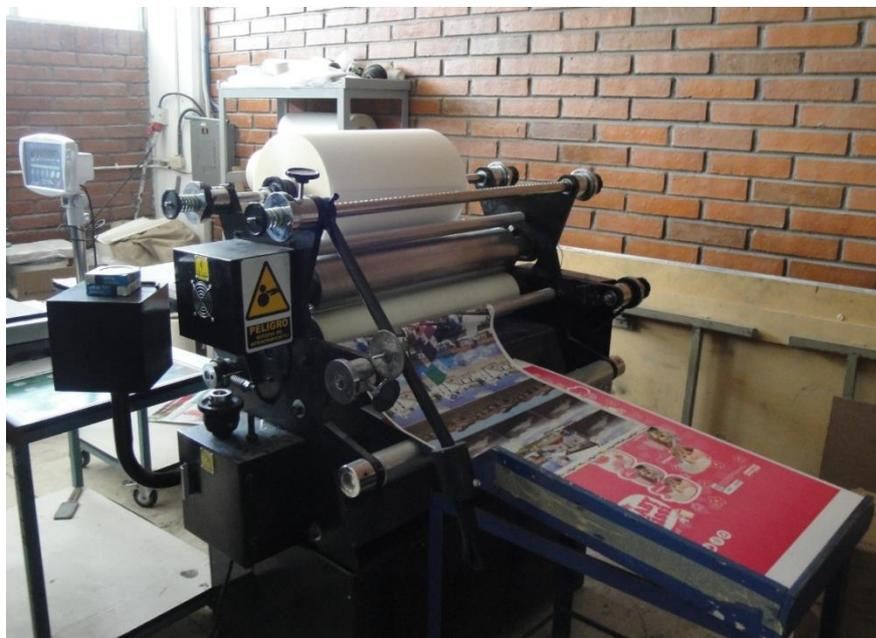
Figura 2.25. Máquina de terminado existente en la Editorial Don Bosco
