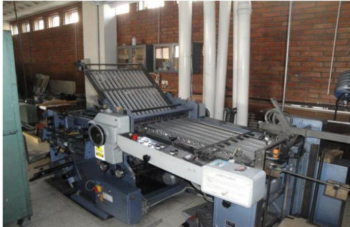
Figura 2.19. Máquina de doblado existente en la Editorial Don Bosco.
