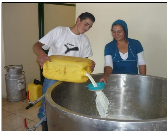
Fotografía 2-2. Requisitos higiénicos del personal: no usan el uniforme y equipos de protección. Asociación Artesanal Llavircay, Lácteos
