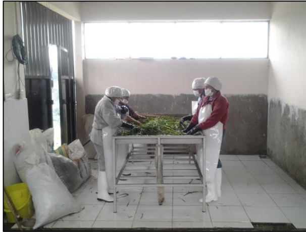
Fotografía 2-1: Operaciones de producción y requisitos de las instalaciones: paredes sin pintar, colocación de productos directamente sobre el piso. Asociación de Artesanos San Pablo de Guarainag, Horchata.
