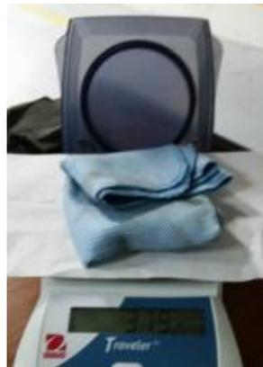
Fig. 2.19. Masa de la tela de microfibra después del proceso de lavado
