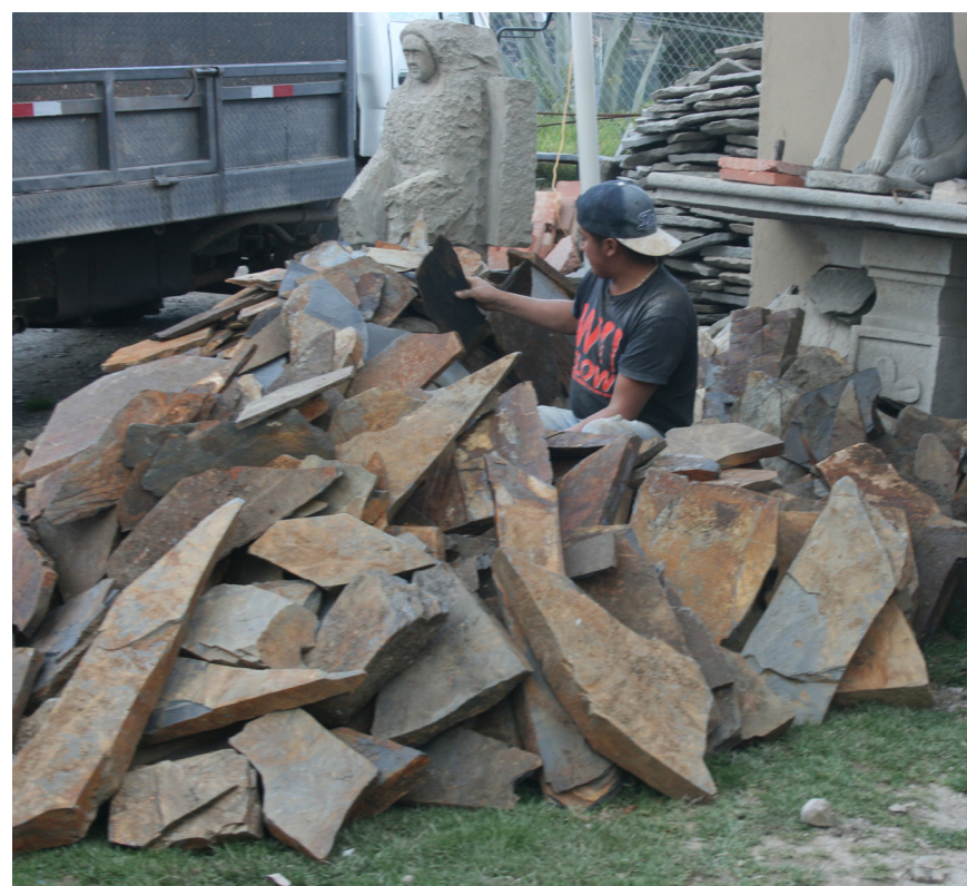
Fig.17: Desbaste por lascado.
