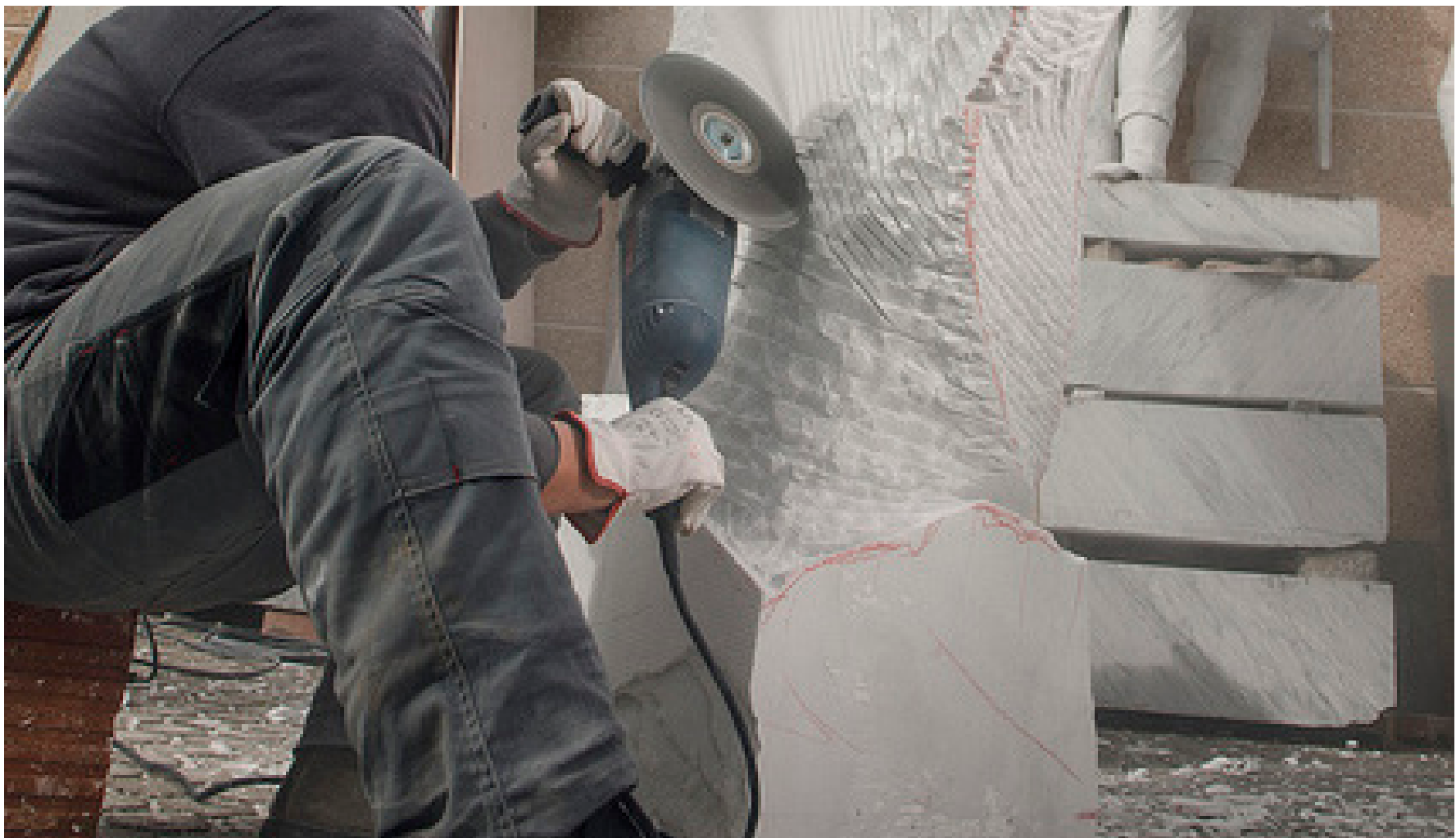
Fig.19: Desvaste con amoladora.
