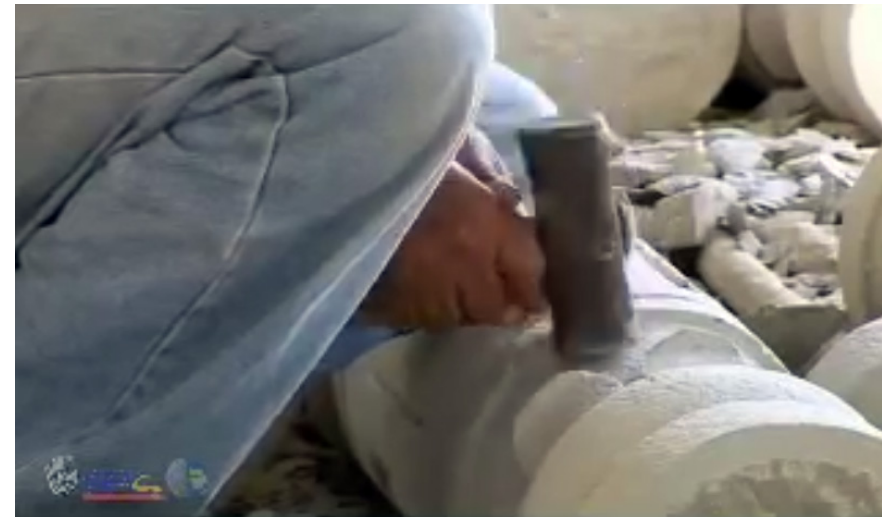
Fig.15: Desbaste usando combo.
