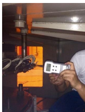
Ilustración 28. Medición de la presión del resorte. (Fuente propia)
