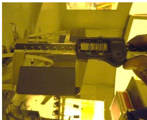
Ilustración 27. Medición de la longitud de una escobilla. (Fuente propia)
