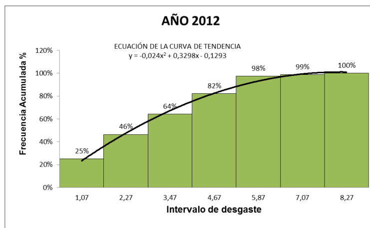
Ilustración 32. Ecuación de la curva de desgaste 2012 (Fuente propia)
