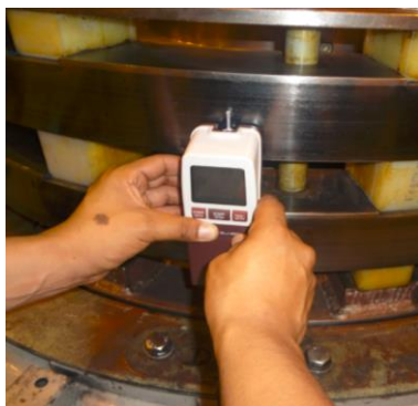
Ilustración 30. Medición de la rugosidad. (Fuente propia)
