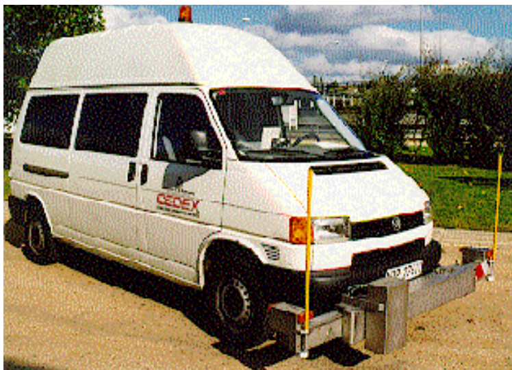
Figura 1.1 Perfilógrafo laser de alto rendimiento
