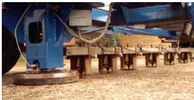
Figura 1.4 Distribución del plato de carga y de los sismómetros
