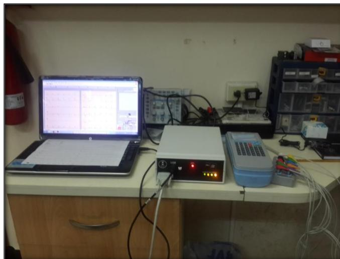
FIGURA 4. 3 Conexión de los instrumentos para las pruebas de calibración y certificación del equipo.
