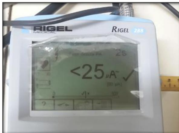
FIGURA 4. 7 Medición de Fuga Directa de Corriente PA.
