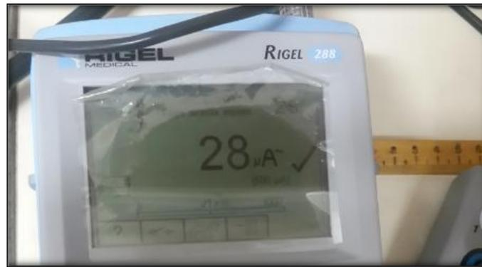
FIGURA 4. 8 Medición Fuga Directa de Corriente.
