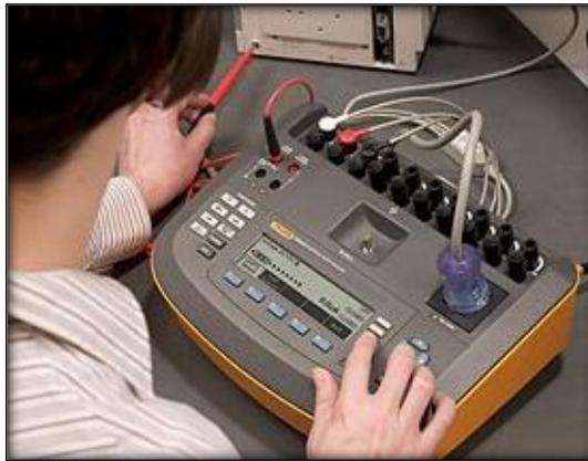
FIGURA 4. 1 Prueba de Seguridad Eléctrica de un Equipo Médico.
