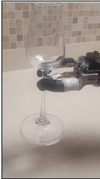
Figura 3.21: Prótesis real sujetando un objeto.
