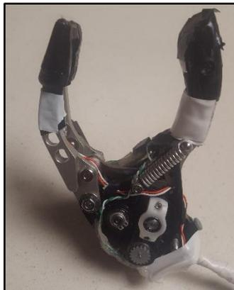
Figura 3.1: Prótesis de mano derecha tipo pinza.
