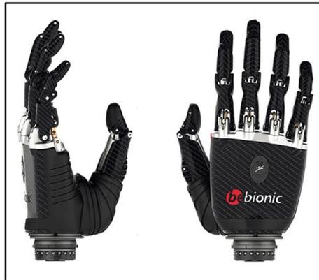
Figura 1.26: Prótesis de mano mioeléctrica Bebionic 3.
