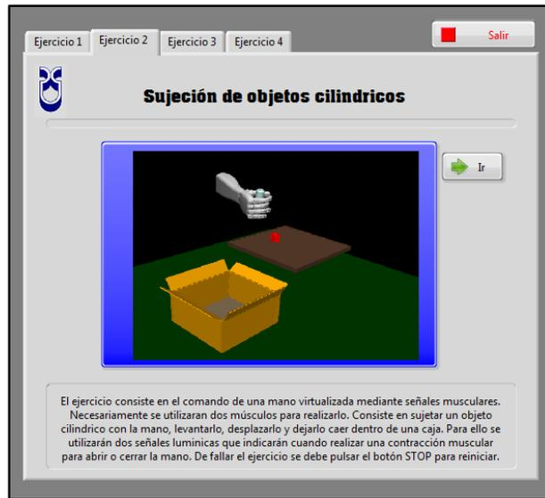
Figura 4.11: Pantalla Principal del entrenador virtual de prótesis mioeléctrica diseñado.
