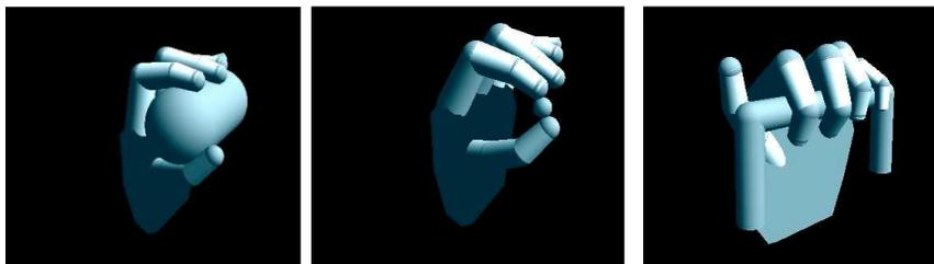
Figura 1.49: Tipos de agarre del entrenador virtual: Agarre cilíndrico, pinza, gancho.
