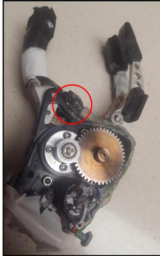
Figura 3.12: Posicionamiento del sensor de efecto hall dentro de la prótesis.
