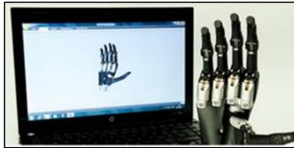
Figura 1.52: Virtu-limb siendo utilizado con una prótesis i-limb quantum.
