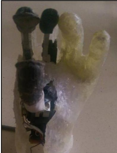
Figura 4.48: Guante de silicón diseñado para la prótesis de mano tipo pinza.
