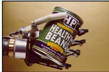
Figura 1.24: Prótesis de mano Southampton sujetando de manera autónoma un objeto cilíndrico.
