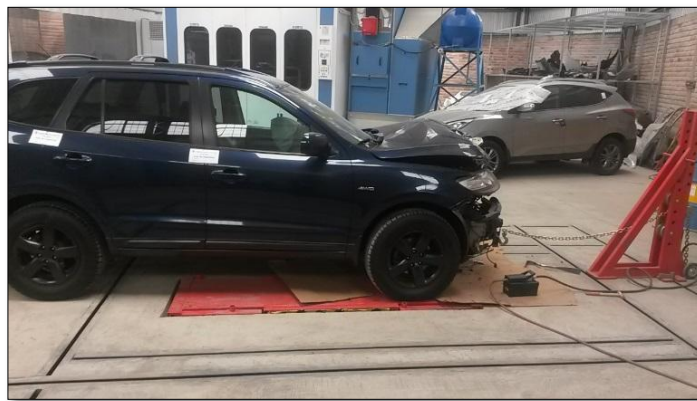
Fig. 3.25 Banco de enderezado (golpes fuertes).
