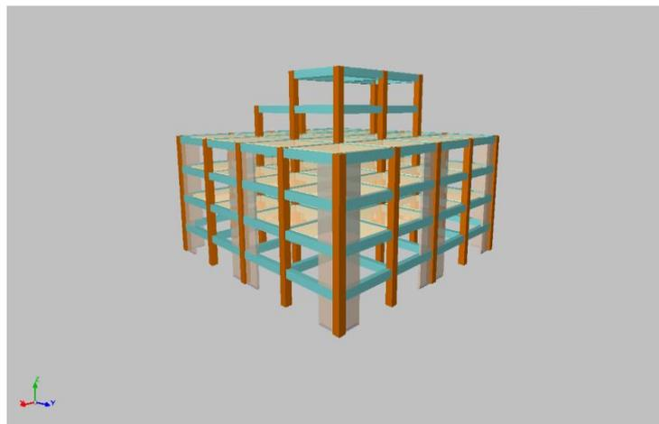
Figura 2.63: Modelo 57: 5 plantas, 5 ejes, luces menores a 6 m, irregular en altura con muro externo
