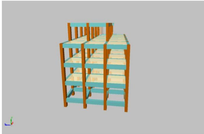
Figura 2.53: Modelo 47: 4 plantas, 4 y 5 ejes, luces mayores a 6 m, irregular en altura con muro interno
