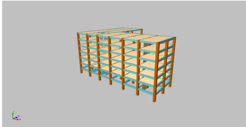
Figura 2.122: Modelo 116: 6 plantas, 6 y 7 ejes, luces mayores a 6 m, irregular en planta con muro interno
