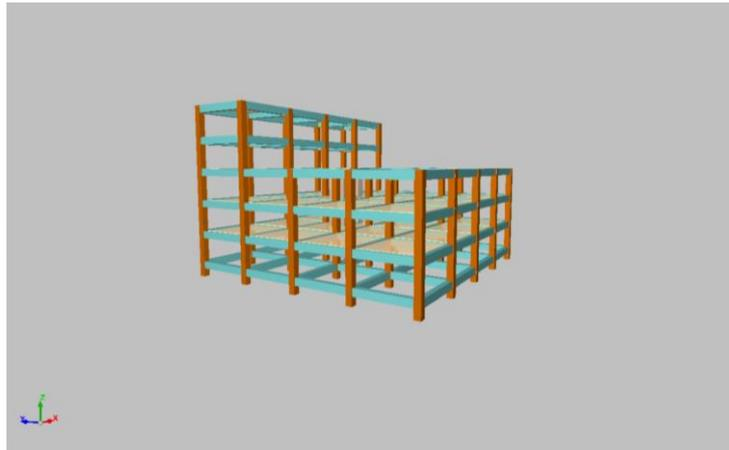
Figura 2.62: Modelo 56: 5 plantas, 5 ejes, luces menores a 6 m, irregular en altura con muro interno
