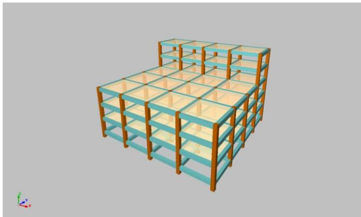
Figura 2.61: Modelo 55: 5 plantas, 5 ejes, luces menores a 6 m, irregular en altura sin muro
