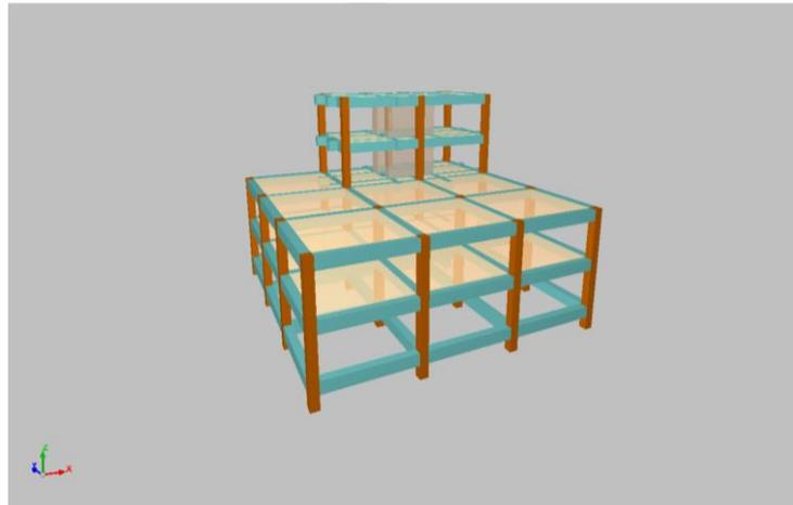
Figura 2.35: Modelo 29: 4 plantas, 4 ejes, luces mayores a 6 m, irregular en altura con muro interno
