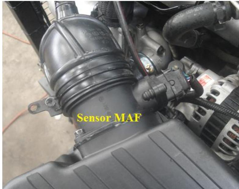
**Figura 1.19** Ubicación del sensor MAF
