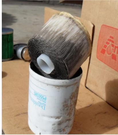
**Figura 1.4.** Filtro de estructura enrollada
