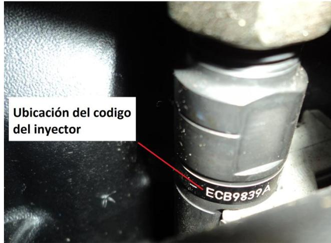
Figura 1.46 Ubicación del código del inyector
