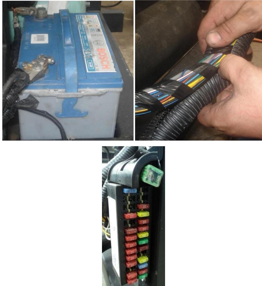
**Figura 2.3** Componentes del sistema de alimentación eléctrica
