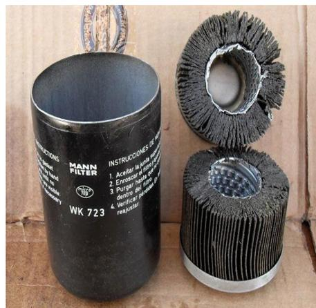
**Figura 1.5**Filtro de estructura plegada
