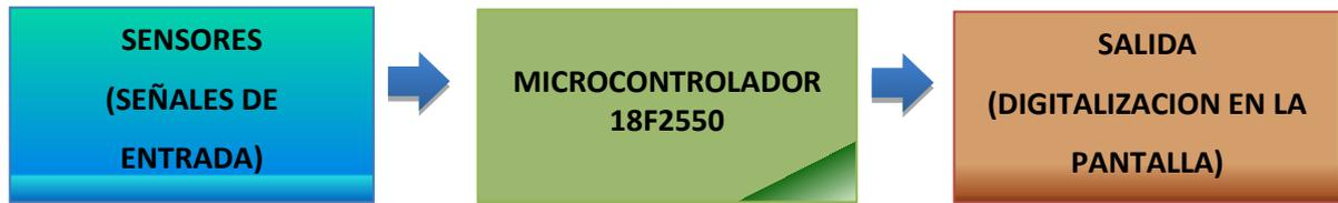
**Figura 3.15** Diagrama de bloques del microcontrolador 18F2550
