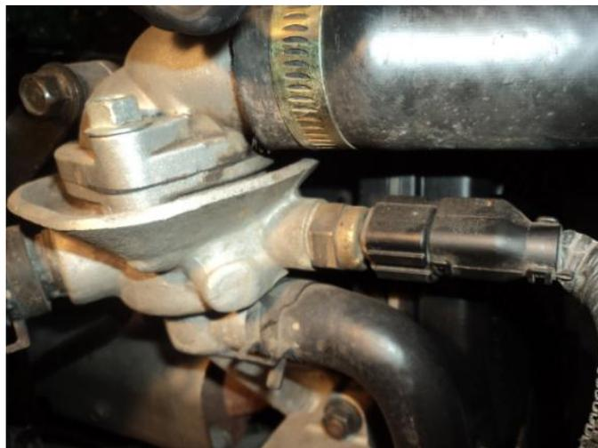
**Figura 1.30** Ubicación del sensor ECT
