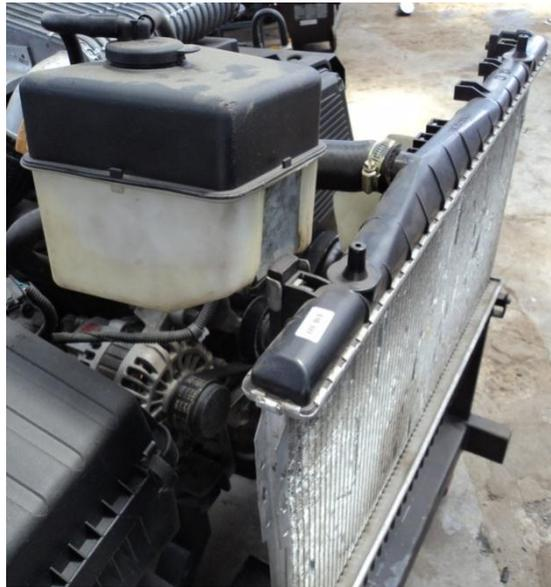
**Figura 2.4** Depósito del refrigerante del motor y radiador
