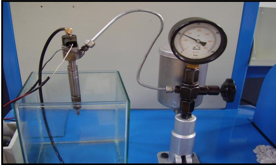
**Nota:** La prueba de presión de inyección se realizó en seis inyectores diesel mecánicos; dos tipo tetón y cuatro de orificios, además, de un inyector electrónico tipo Bosch.
