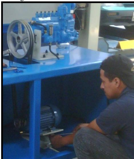
Es necesario tensar correctamente las correas de transmisión, para ello se consta de una platina (**figura 4.13**) la cual se la deberá mover y ajustar mediante el perno y tuercas de calibración para el correcto tensado de las correas.
