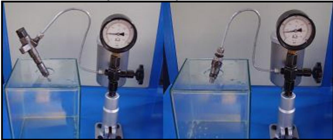
**Nota:** La prueba de presión de retorno se realizó en cinco inyectores diesel mecánicos; dos tipo tetón y tres de orificios.
