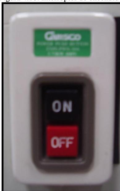
El motor trifásico puede girar en ambos sentidos, dependiendo del giro de la bomba de alimentación se verificará el giro en el motor, para invertir el giro solo basta cambiar la posición de los cables negro y verde (**figura 4.7**) en el interruptor, esto invierte el sentido de la corriente lo cual permite al motor cambiar su sentido de giro.
