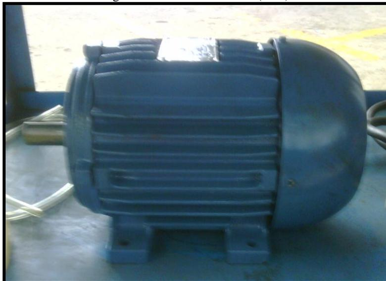
Además, se debe controlar las conexiones de alimentación de la fuente al motor, las cuales están ubicadas en la parte posterior del motor. Como las condiciones de servicio son tan variadas, los periodos de inspección dependen del sitio de instalación; sin embargo, el banco de pruebas se recomienda verificarlo cada 20 pruebas que en éste se realice.
