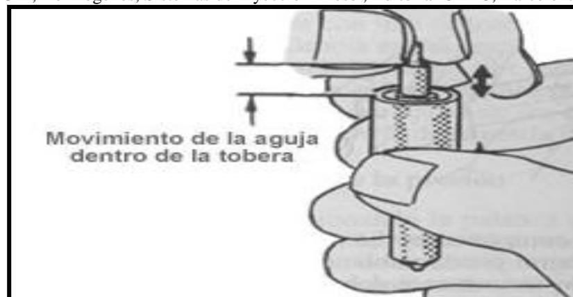
En el porta-inyector deberá comprobarse la varilla de empuje, que no debe estar deformada ni presentar señales de golpes o deformaciones, prestando especial atención a su estado de desgaste. También debe comprobarse el estado del muelle y el dispositivo de reglaje.
