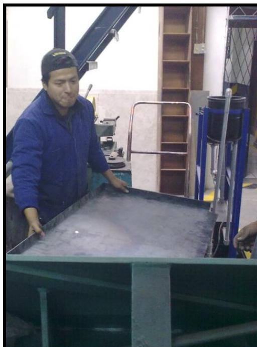
Foto 7. Proceso de amolado de la estructura.
