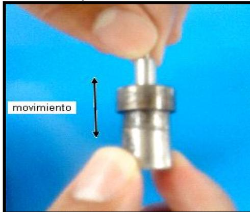
Figura 5.10. Comprobación de los muelles y varilla de empuje.
