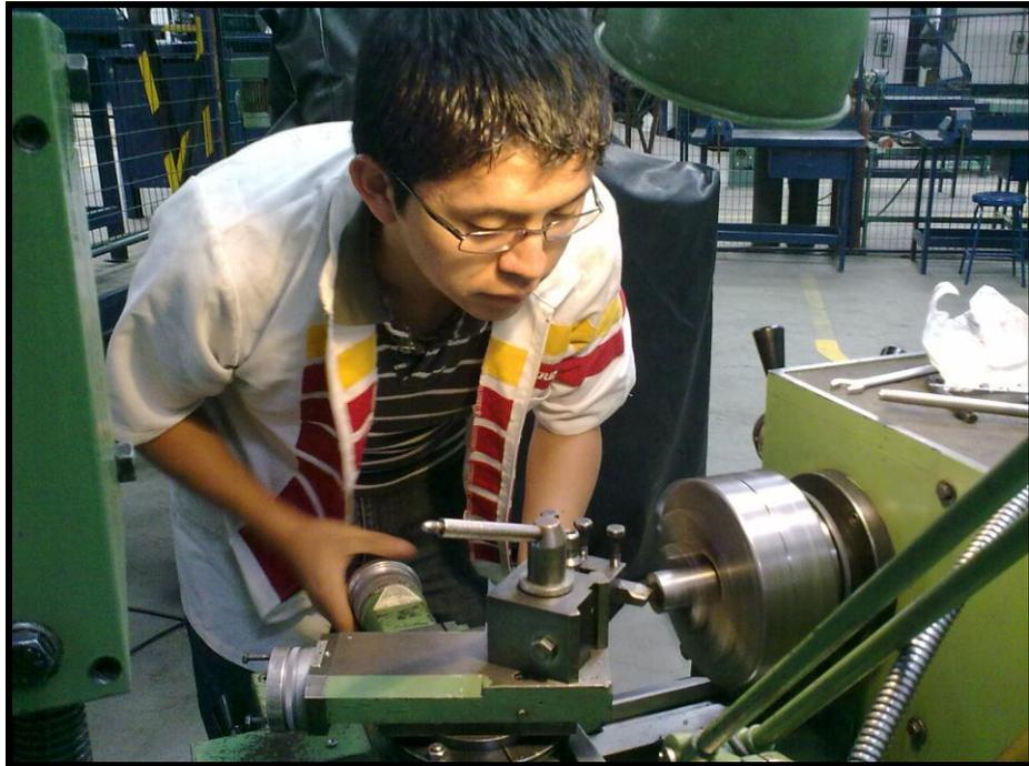
Foto 10. Moleteado de la palanca del probador de inyectores.
