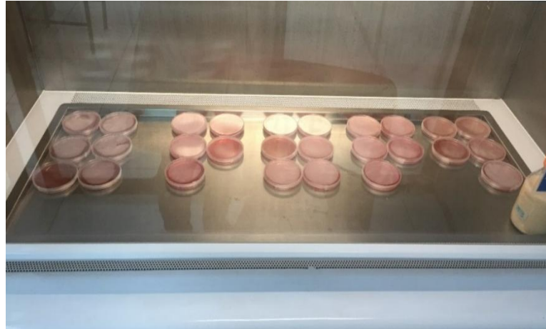
Figura 2.2: Siembra de las cepas en Agar Sangre en la cámara de flujo laminar.
