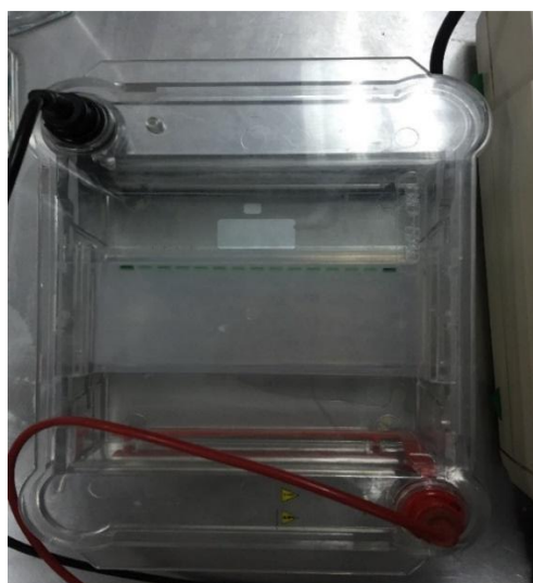
Figura 2.18: Muestras colocadas en la cámara de electroforesis.
