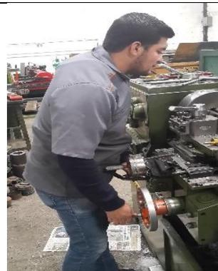
b) Maquinado del eje de la mangueta
