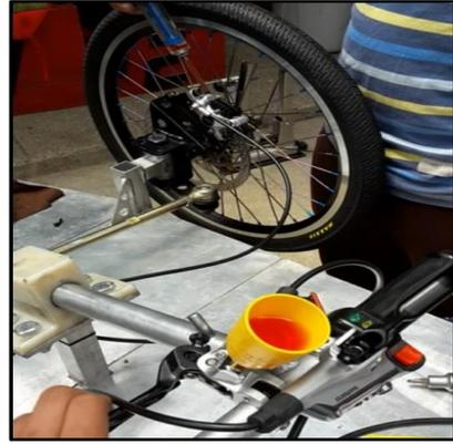
Figura 5.8. Purgado del sistema de frenos
