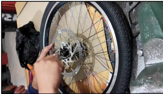
Figura 5.1. Acoplado del disco al conjunto manzana – rueda
