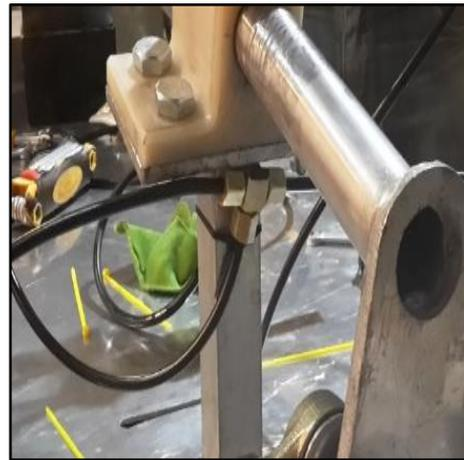
Figura 4.10. Válvula bidireccional
