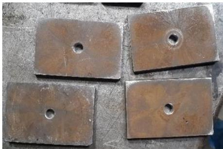
a) Orificio central en placa lateral de la mangueta
