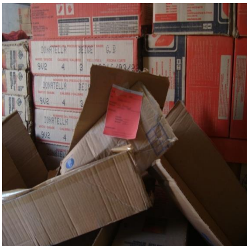
Ilustración 25: Colocación de tarjetas rojas Fuente: Tamara Pauta
