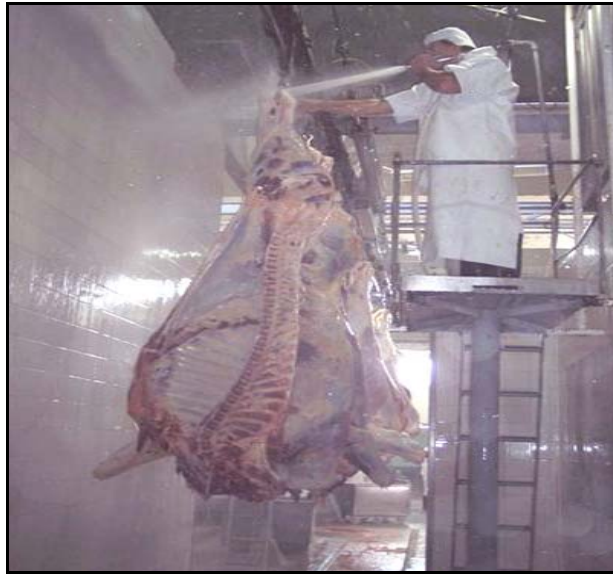
Fotografía 5 - 12: Lavado de canales.
