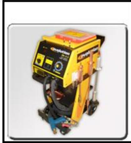
**FIGURA # 31** Desabollador eléctrico.
