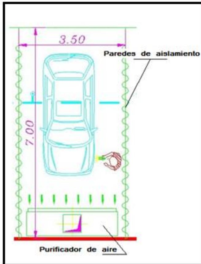
**FIGURA # 22** Dimensiones adecuadas de una bahía de enderezado y pintura express.
