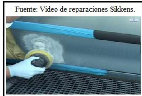
**FIGURA # 47** Lijado mecánico.
