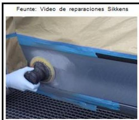
**Figura # 54** Lijado mecánico.
