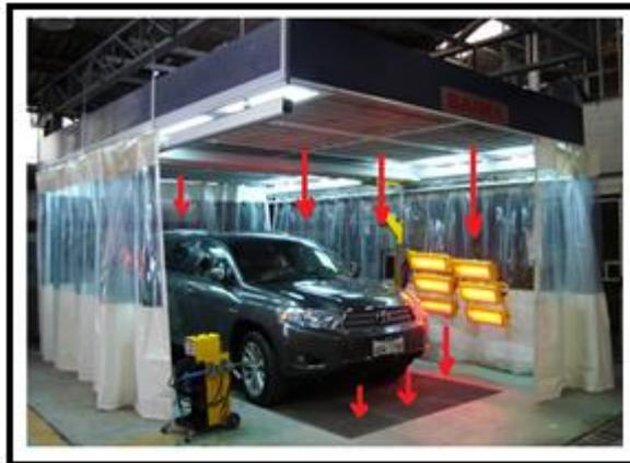
**FIGURA # 24** Bahía de enderezado y pintura express de barrido descendente.
