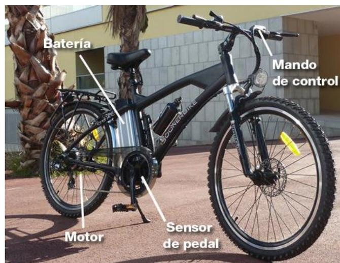
Figura 1.1 Partes bicicleta eléctrica.
