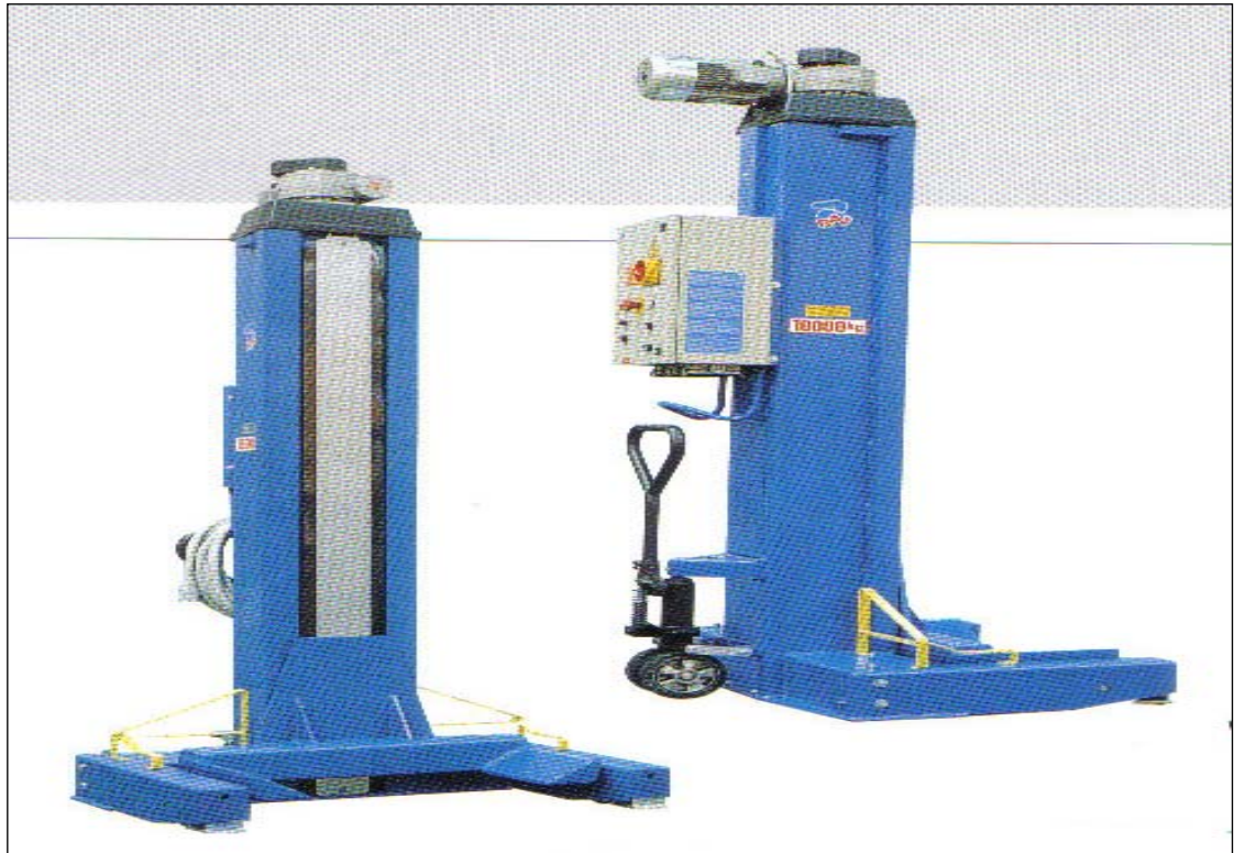
Figura 2.4 Elevadores de columnas independientes, en reposo (a), en trabajo (b).
