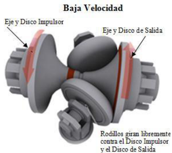
Figura 2.2.2 CVT Toroidal Baja Velocidad
