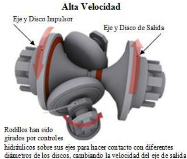
Figura 2.2.3 CVT Toroidal Alta Velocidad
