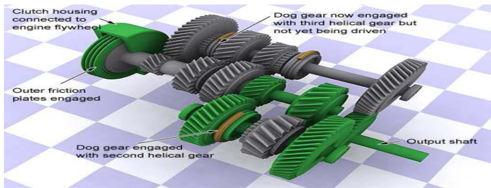
Figura 1.3.6 Segunda marcha seleccionada. Tercer engranaje preseleccionado
