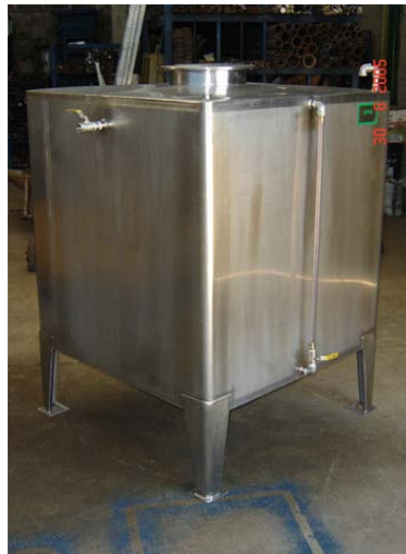
Fig. 2-8 Tanque de almacenamiento para biodiesel
