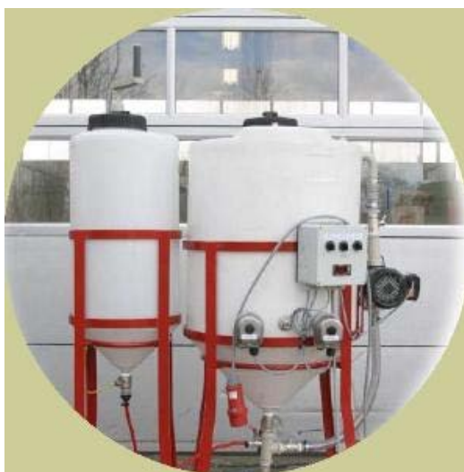
Fig. 3-3 Decantación de biodiesel
