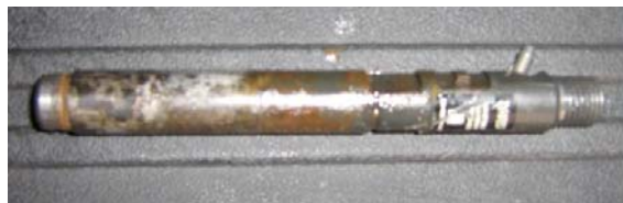
Figura 1.10 Presencia de óxido en el inyector
