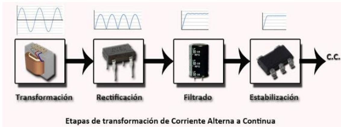
Figura 3.20 Estructura de una fuente de alimentación
