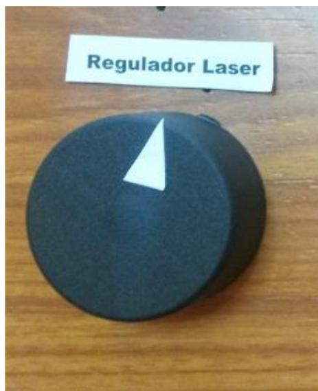
Figura 5.3: Control manual de intensidad láser
