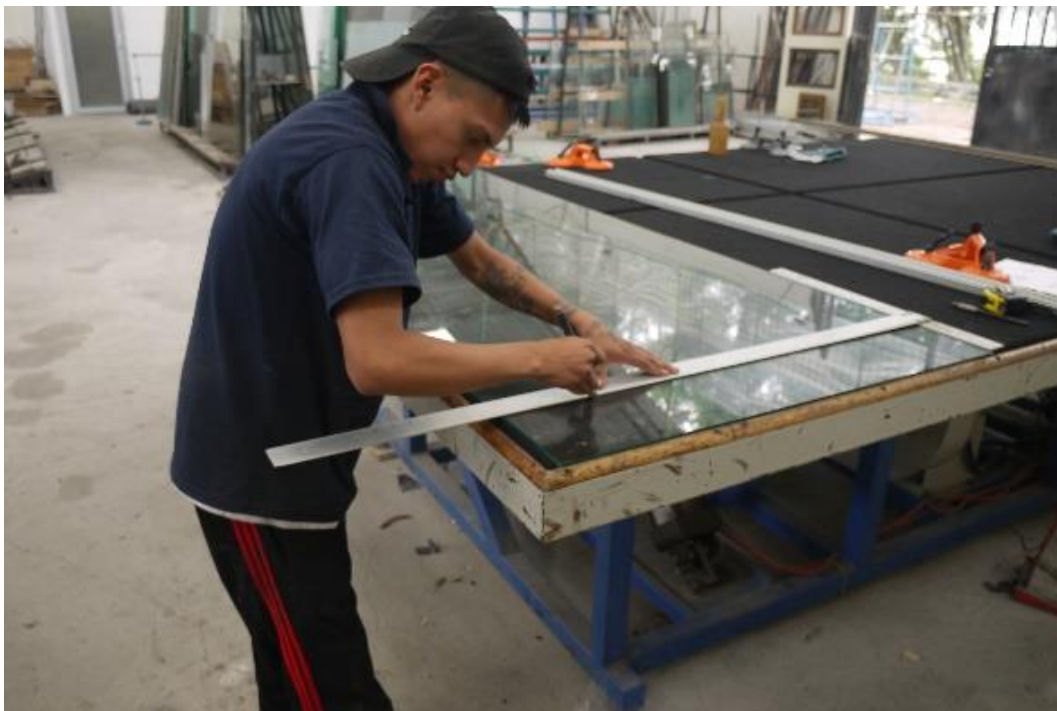
Figura 1.15: Traslado y corte de vidrio
