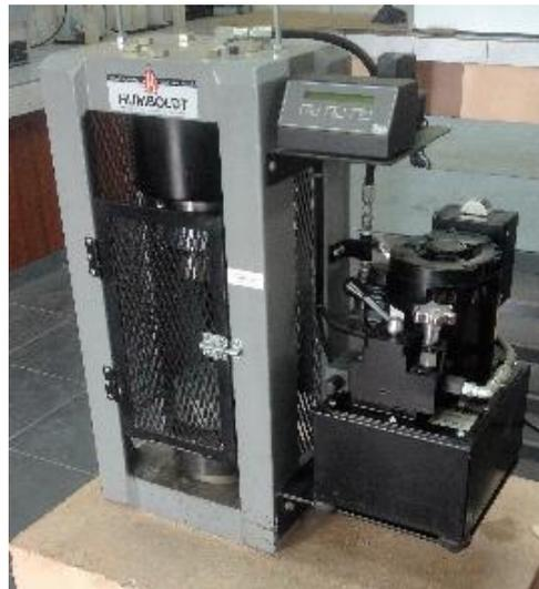
Figura 3.7: Prensa hidráulica 250000 lb
