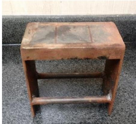
Figura 3.10: Dispositivo para aplicación de cargas en ensayo a flexión
