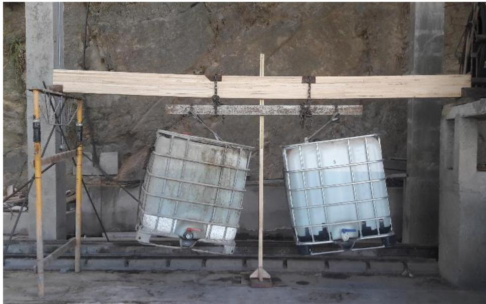
Figura 3.20: Ensayo de flexión en MLE a escala real
