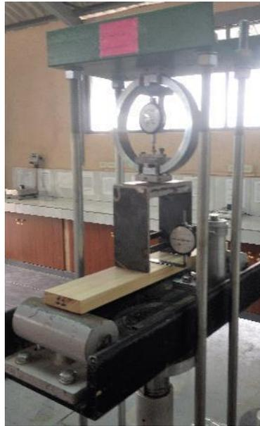
Figura 3.15: Ensayo a flexión en eucalipto
