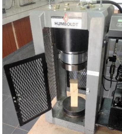
Figura 3.12: Ensayo de compresión en eucalipto
