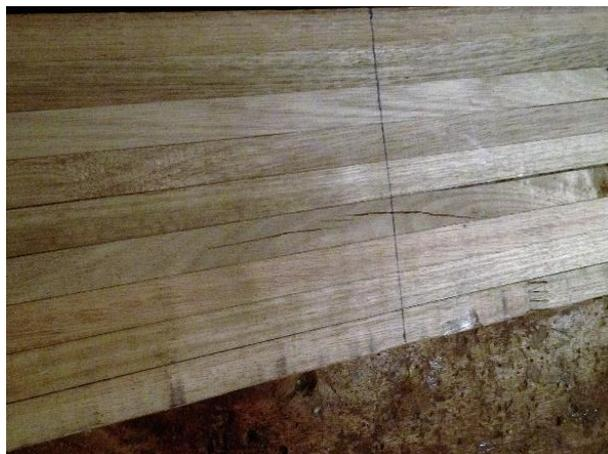
Figura 4.1: Fallo por flexión en la madera laminada
