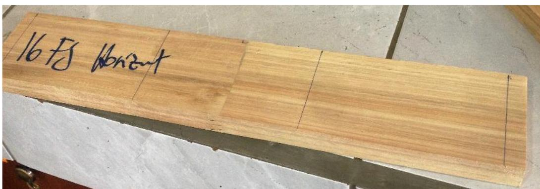
Figura 3.18: Probeta con unión finger joint horizontal
