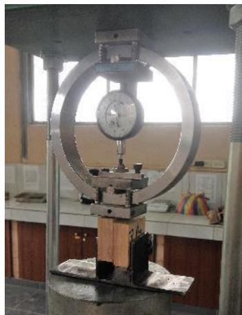
Figura 3.16: Ensayo de cortante en la línea de cola en eucalipto.
