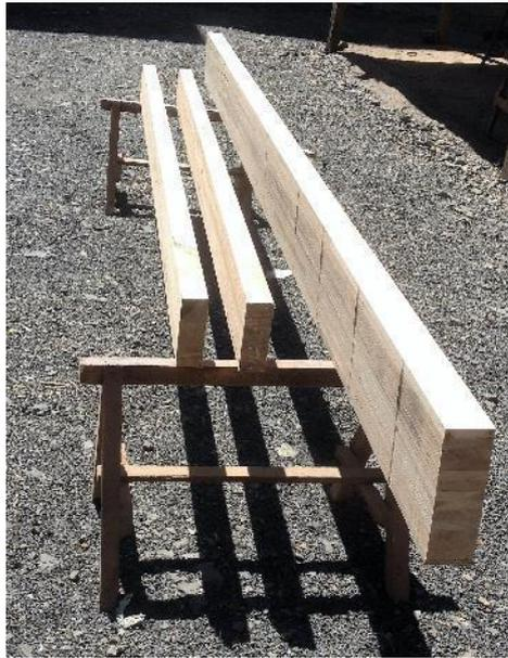
Figura 3.19: Vigas de madera laminada de eucalipto
