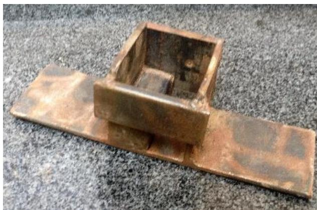
Figura 3.11: Dispositivo de soporte en ensayo a cizalle
