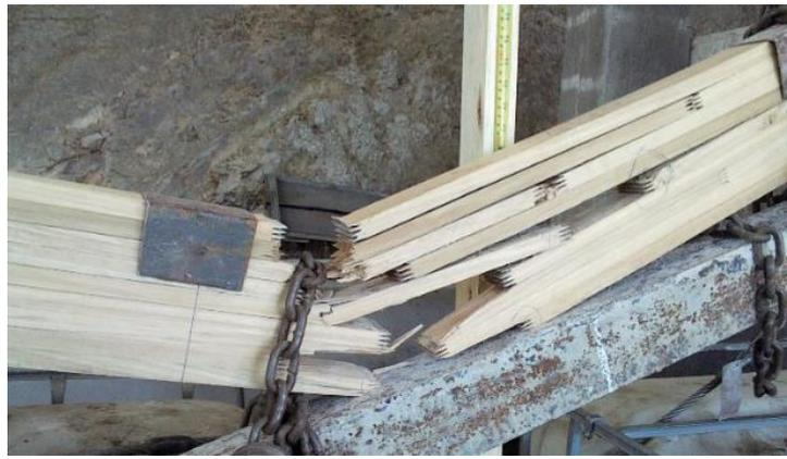
Figura 4.2: Fallo de la madera laminada por flexión
