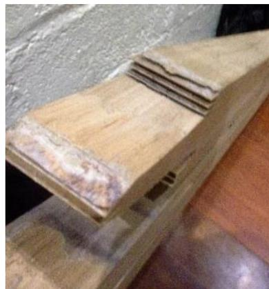
Figura 4.3. Fallo por desprendimiento de cola en las uniones dentadas
