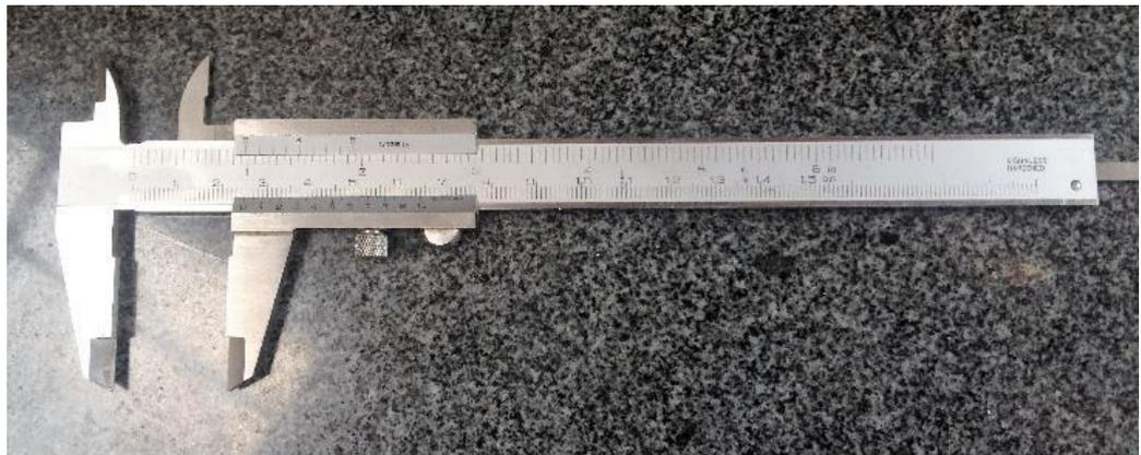
Figura 3.6: Calibrador
