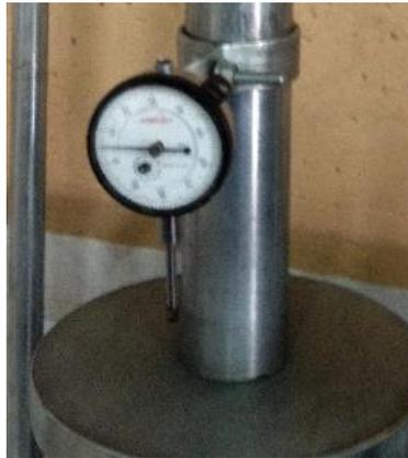
Figura 3.9: Deformímetro 0.001 in de precisión
