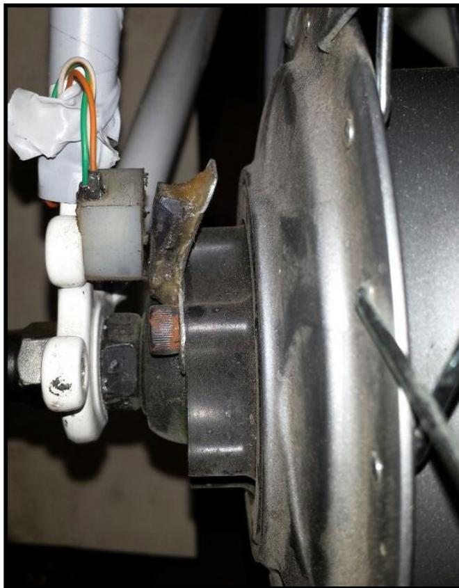
Figura 2.3. Ubicación del sensor de Hall, junto al cuadro; y el imán, junto al CVT.
