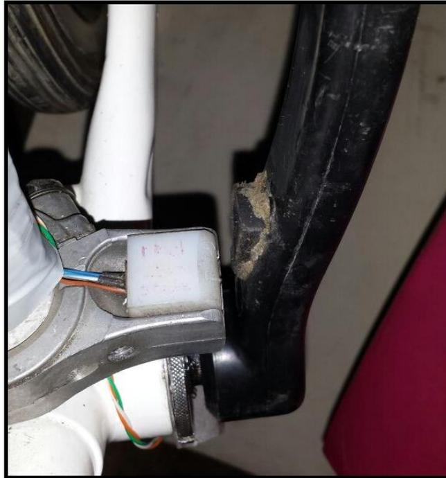
Figura 2.4. Ubicación del sensor de Hall, junto al cuadro; y el imán, junto al CVT.
