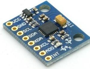
Figura 1.6. MPU-6050 Giroscopio con tecnología micro-electromecánica (MEMS).
