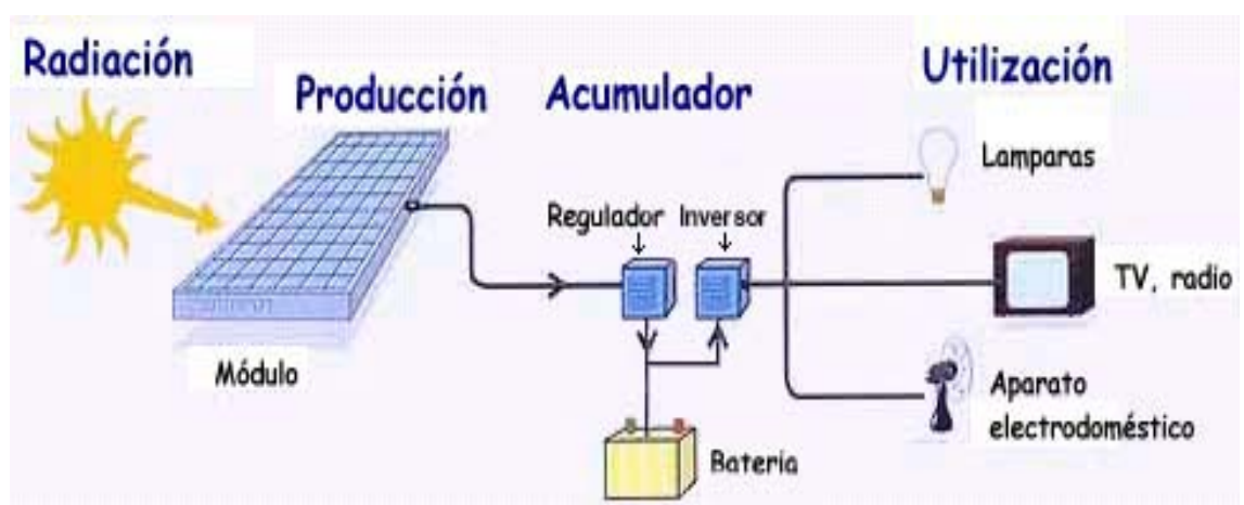
Ilustración 1: Funcionamiento del Sistema Fotovoltaico
