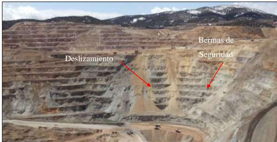
Figura 1.9. Bermas de seguridad sosteniendo material de deslizamiento.
