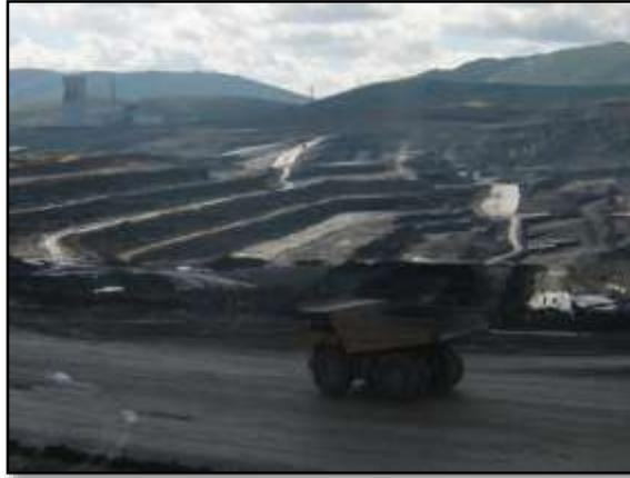
Figura 1.3. Explotación por método de terrazas.
