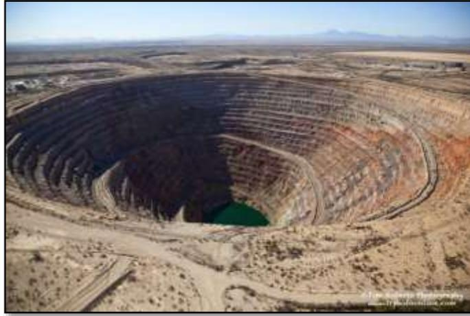
Figura 1.1. Explotación por método de cortas.
