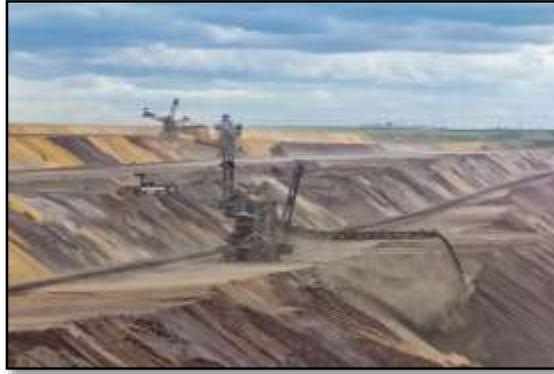
Figura 1.2. Explotación por método de descubiertas.
