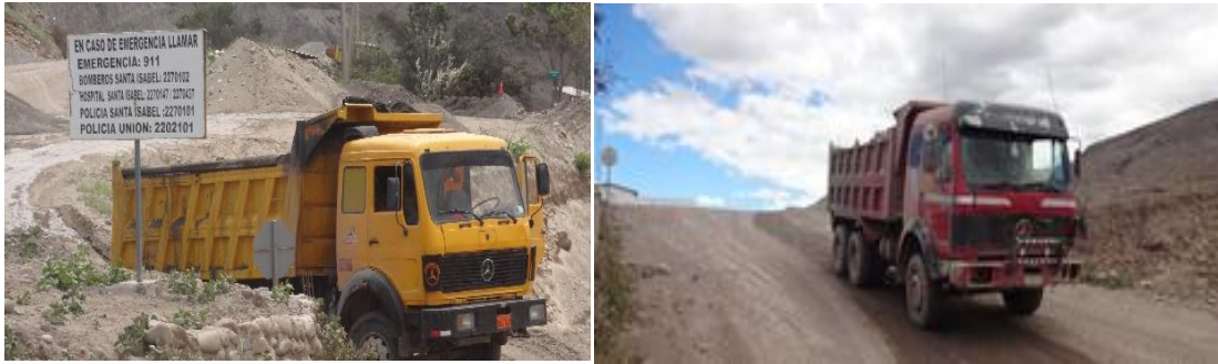
Figura 3.6. Volquete utilizadas para la carga y transporte interno
