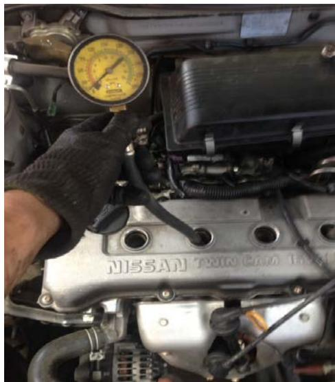
Fig. 4.5 Manómetro de medición de compresión en motores.
