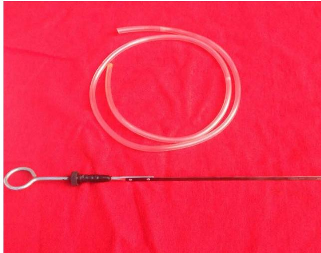
Fig. 2.4 Manguera de succión y varilla de nivel de aceite motor.
