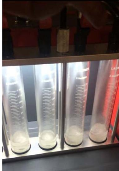
Fig. 4.1 Prueba de pulverización de inyección en banco de pruebas.
