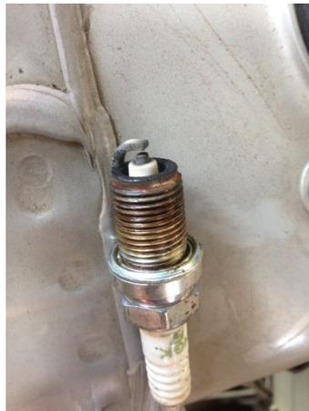
Fig. 4.7 Verificación visual del estado de la bujía.
