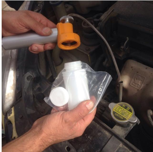
Fig. 2.8 Bomba de vacío y recipiente dentro de funda hermética.
