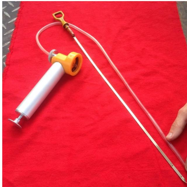
Fig. 2.1 Extensión de la manguera de succión con respecto a la varilla de nivel de aceite motor. Fuente: Los Autores.
