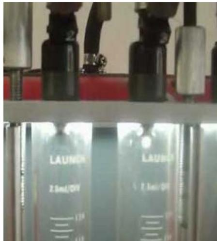
Fig. 4.2 Prueba de estanqueidad en banco de pruebas.
