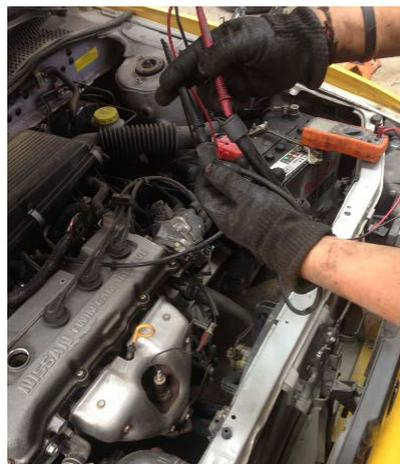
Fig. 4.8 Comprobación de la resistencia interna en cables de bujías.
