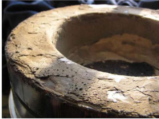
Fig. 1.4.- Resinas adheridas en pistón de motor Diésel.
