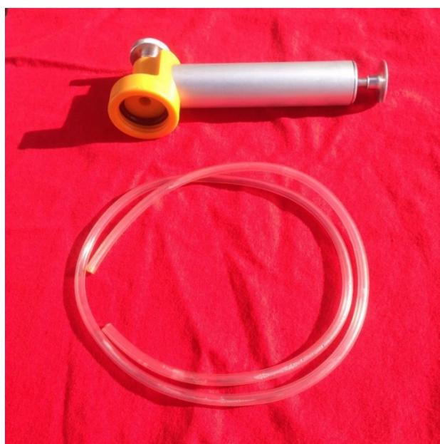
Fig. 2.3 Bomba de vacío
