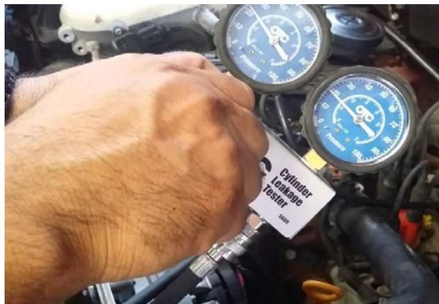
Fig. 4.6 Herramienta para medir fugas de compresión en los cilindros.
