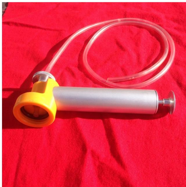
Fig.2.7 Bomba de vacío para muestras de aceite.
