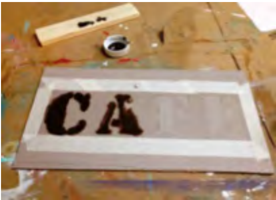
Imagen 60. Plantillas de cartón para grabar letras en superficies planas
