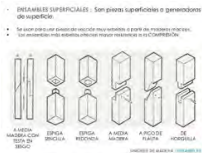
Imagen 87. Tipos de ensamblajes en maderas.
