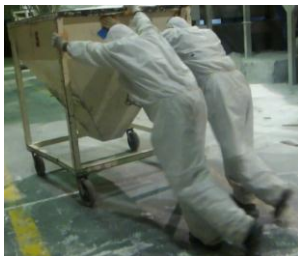
Figura 47. Empuje de tolvas entre dos operadores. Fuente: Autor
