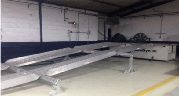
Fig. 3 Dinamómetro de chasis utilizado en las pruebas de medición de consumo de combustible
