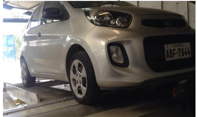
Fig. 8 Medición del consumo de combustible en el dinamómetro de chasis Kia Picanto.
