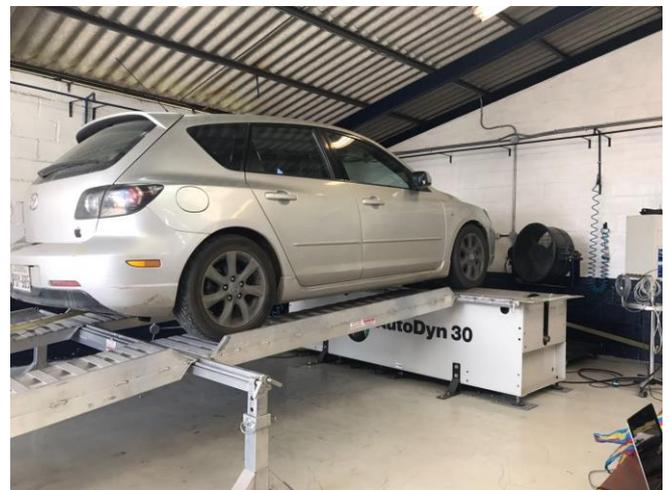
Fig. 9 Medición del consumo de combustible en el dinamómetro de chasis Mazda 3.
