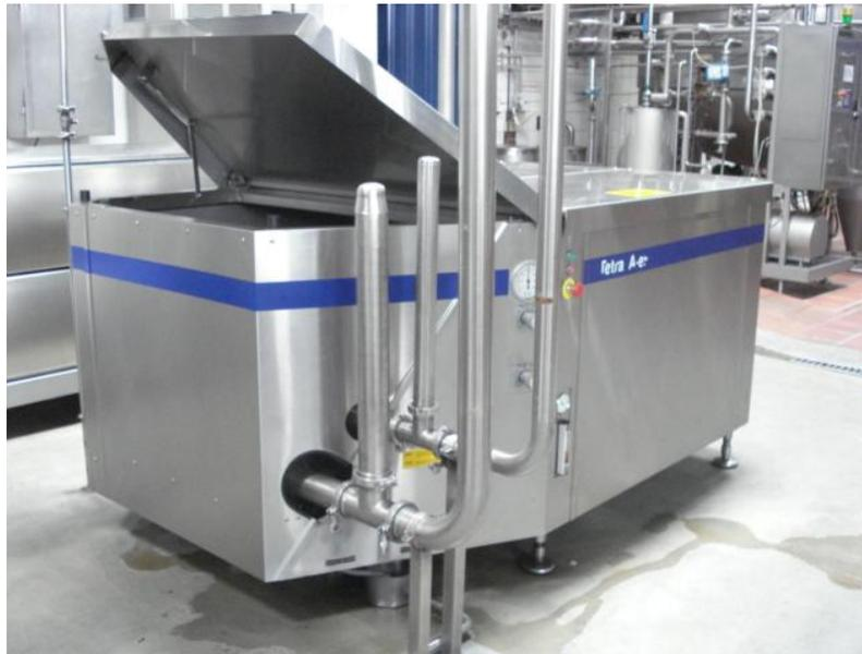
**Figura 6.** Homogenizador.
