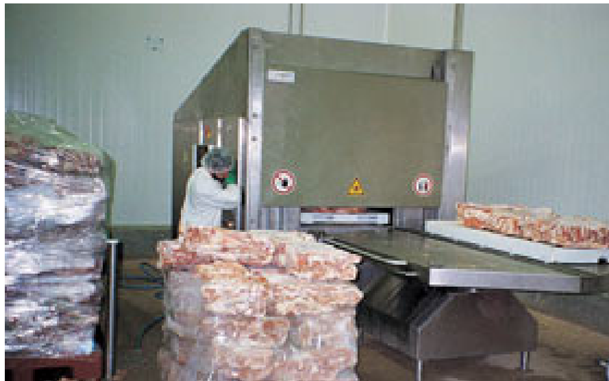
Fotografía 3.1 Microondas Sairem Tipo Batch (915 MHz 60 kW, 800 a 1400 kg/h)
