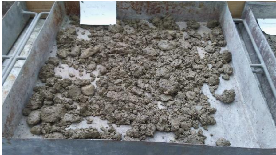
Figura 3.14 Secado de las muestras de diferente calicata tomada de la malla de exploración con su código de identificación
