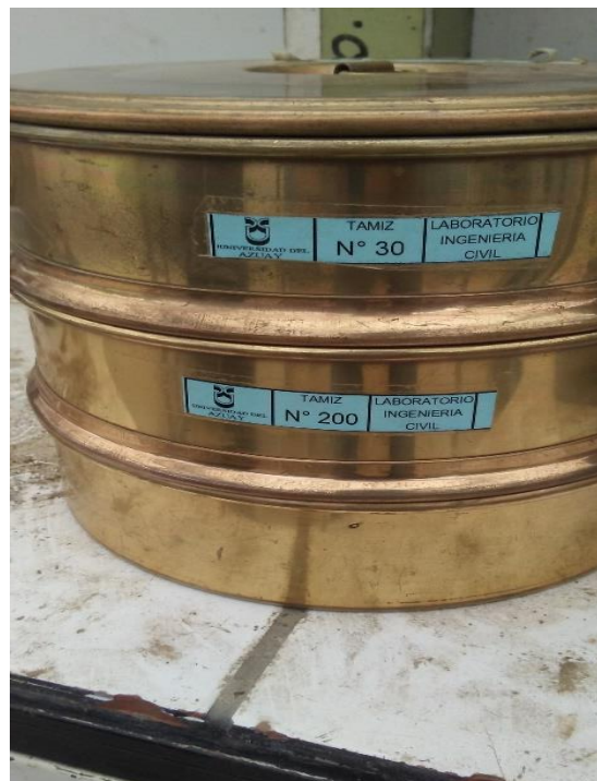
Figura 3.17 Tamizado de las muestras por medio de la malla No 30 y No 200
