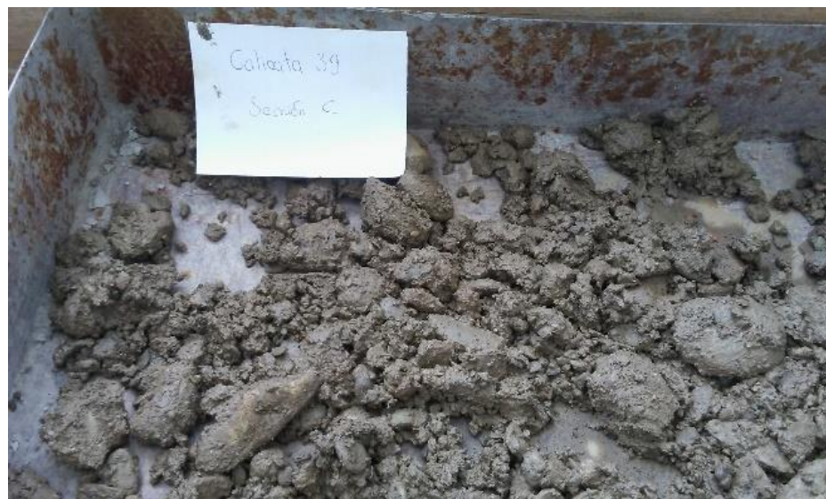
Figura 3.13 Secado de las muestras de diferente estrato con su código de identificación
