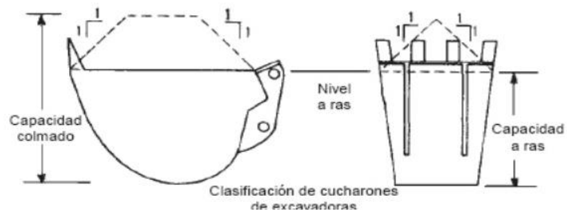
Figura 5.8 Diferencia entre capacidad de cucharón colmada y ras
