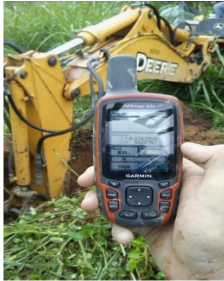
Figura 2.10 Punto de orientación con GPS para ubicación de la calicata en el diseño de malla
