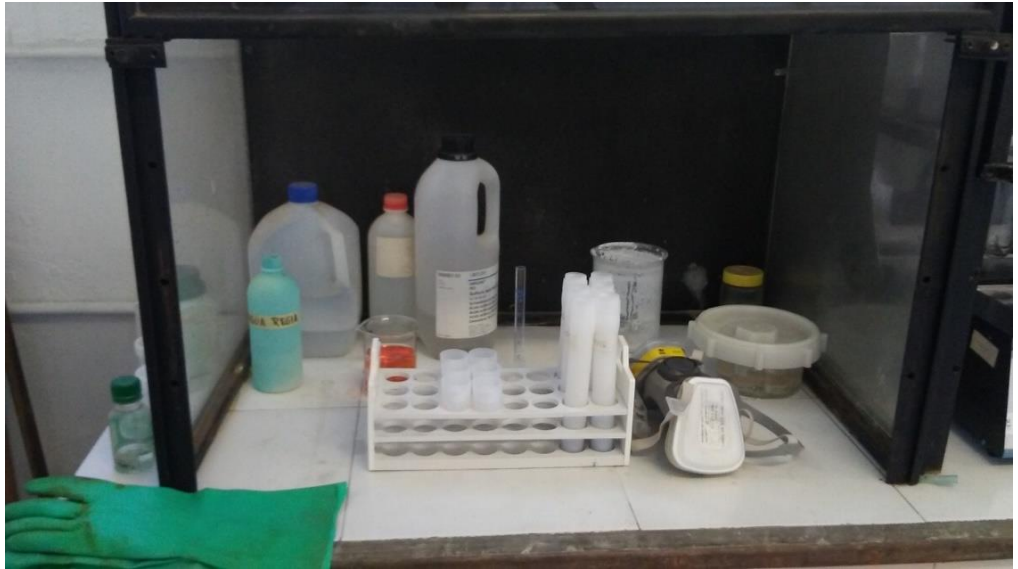
Figura 3.26 Tubos para la puesta de soluciones para su posterior digestión en el microondas.
