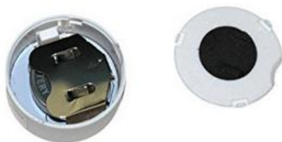
Figura 34: Hardware de un Beacon (NYVIDA, 2017)
