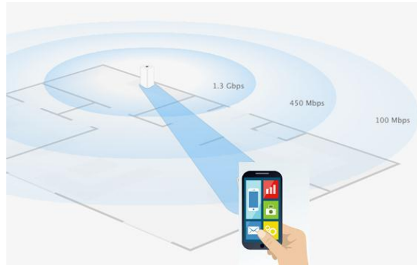
Figura 4: Atenuación de la Señal (tartigues, 2014).
