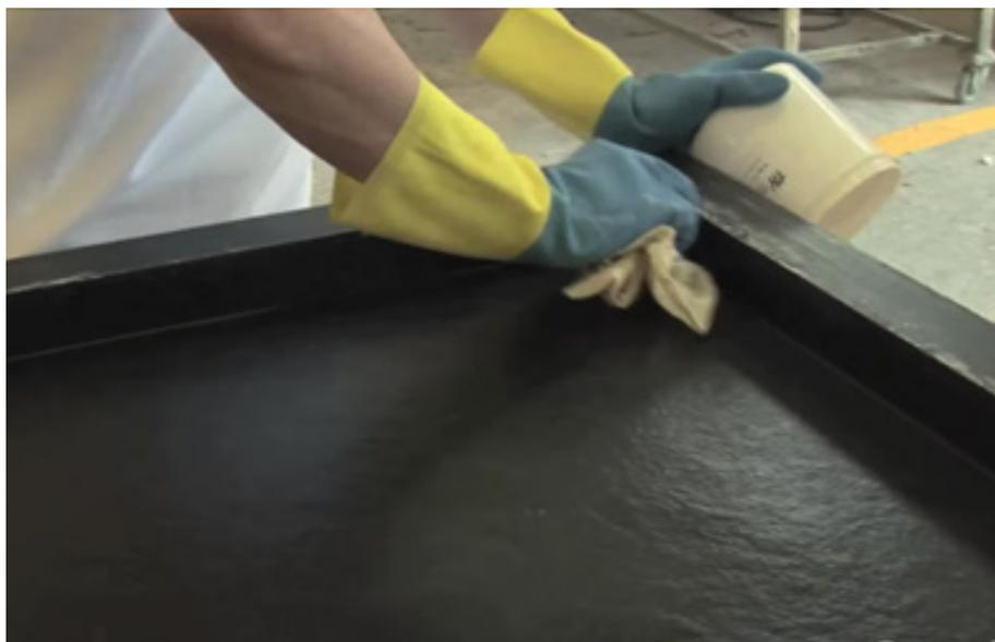
Figura 9: Preparación molde Tineta PRFV
