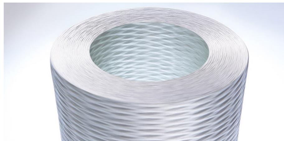
Figura 5: Rollo filamento fibra de vidrio Roving
