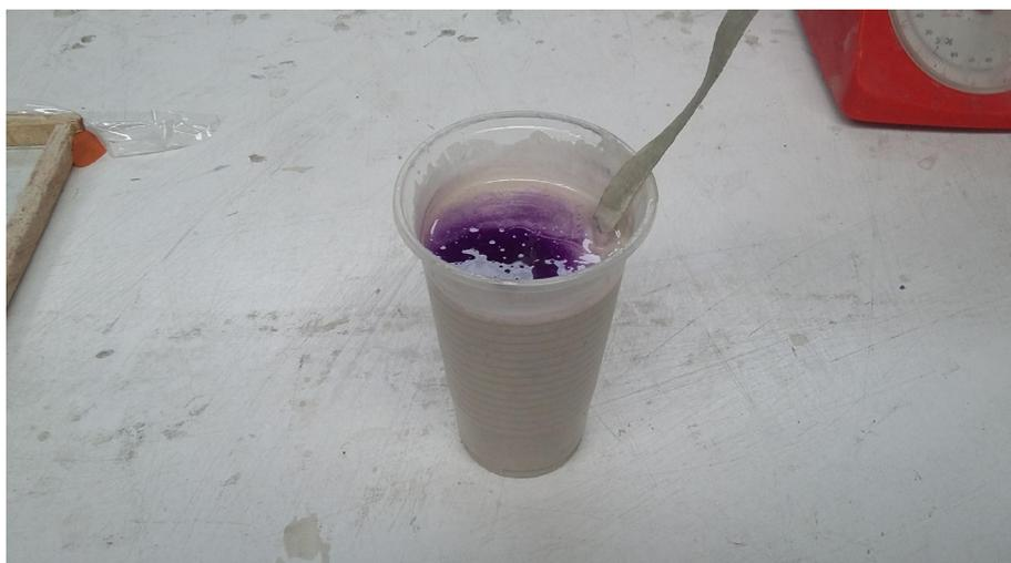
Figura 44: Dosificación de acelerante cobalto
