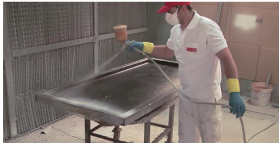
Figura 10: Proceso de aplicación de gelcoat en el molde
