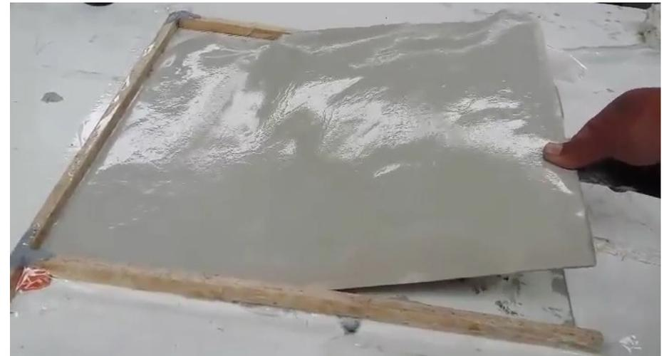
Figura 49: Desmoldado de probeta
