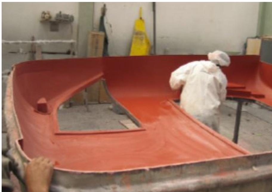
Figura 17: Molde discontinuado de PRFV
