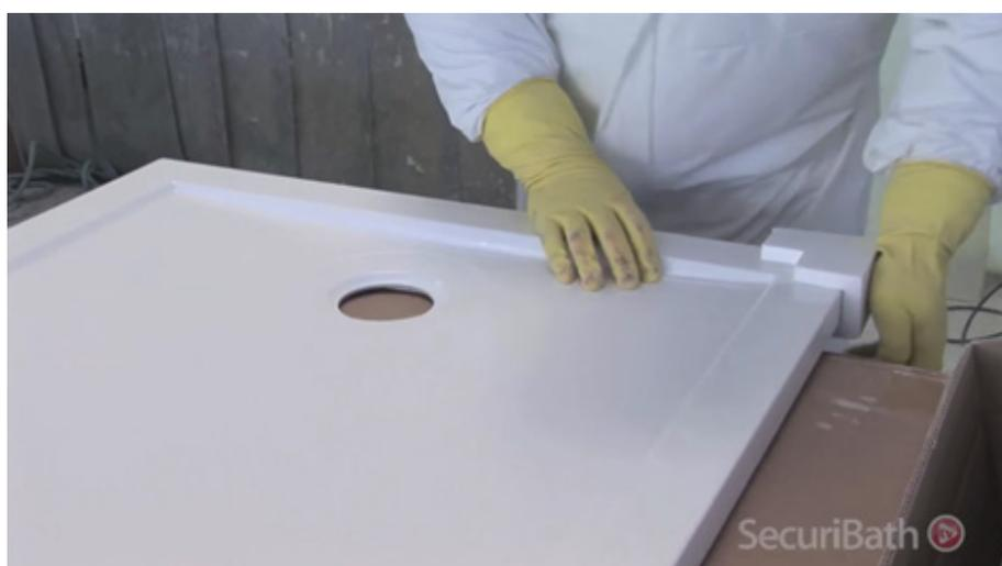
Figura 13: Proceso de terminado y empacado de tineta de PRFV
