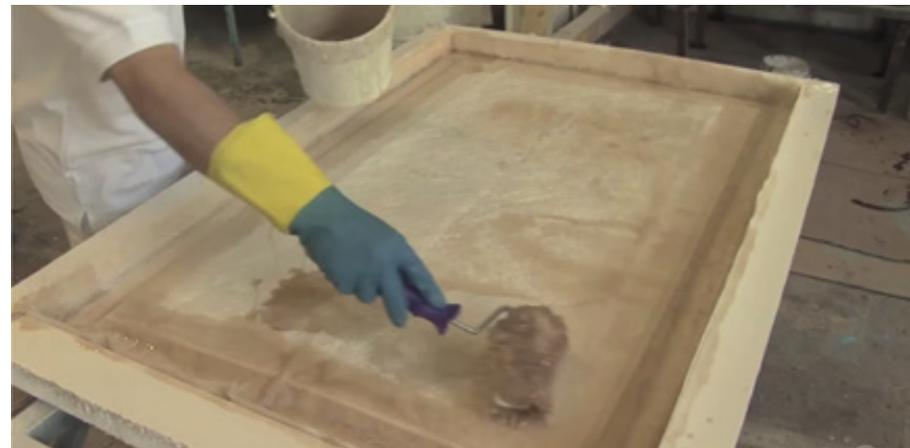
Figura 11: Proceso de lamiado de PRFV
