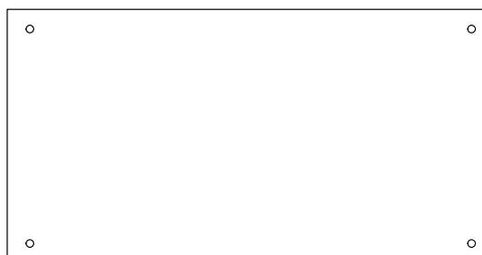
Vidrio Templado de 6mm colocado con 4 puntos fijos pequeños de 4mm .
